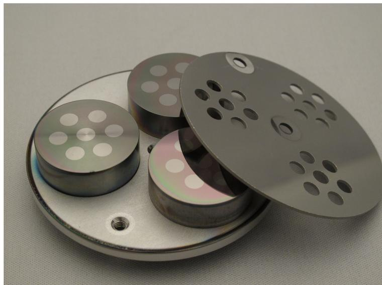
Abbildung 4.4: Untersuchte Probekörper in ihrer Halterung und Maske für die Beschichtung der einzelnen Messpunkte
