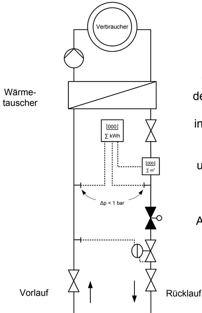
Anordnung des Volumensensors und des Rücklauftemperaturfühlers in Fließrichtung vor dem Regelventil und dem Differenzdruckregler, um eine Druckdifferenz kleiner dem empfohlenen Maximalwert nach Anlage C (z.B. bei 10 K Temperaturdifferenz 1 bar) zu erreichen
