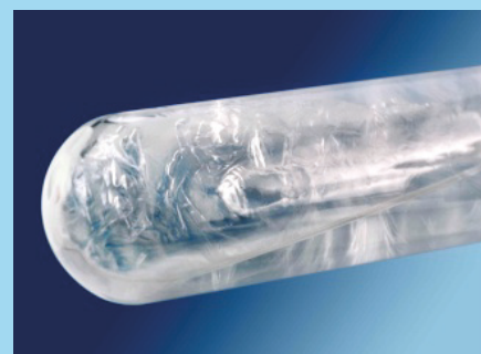
Ячейка реперной точки воды
