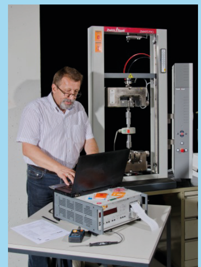
Kalibrierung einer Werkstoffprüfmaschine
