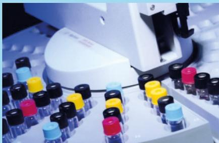
Proben für die gaschromatographische Analyse
