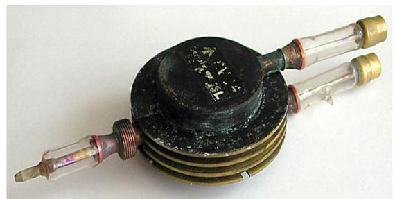
CV 64, frühes britisches Resonatormagnetron, das ab Oktober 1942 im britischen H2S-Radar eingesetzt wurde. Es war das erste britische Magnetron, das in Großserie gefertigt wurde. (Quelle: <http://www.hts-homepage.de/Magnetrons/CV64.html>)
