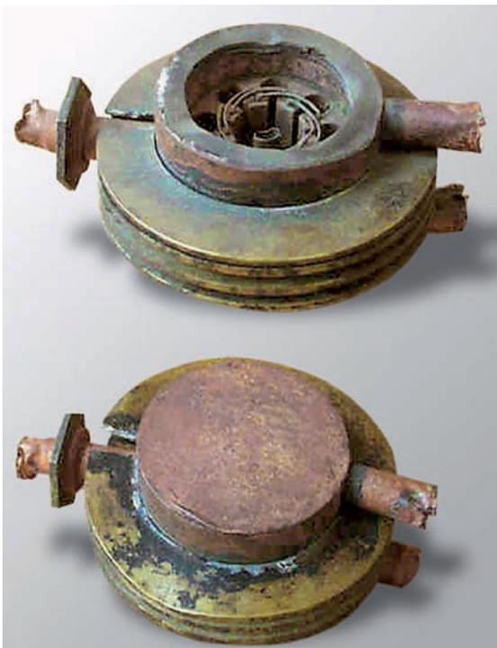
Direkter Nachbau des Magnetrons, das aus einem abgeschossenen Bomber bei Rotterdam stammte. Leistung: 15 kW bei 9,1 cm Wellenlänge. (Quelle: <http://www.hts-homepage.de/Magnetrons/LMS10.html>)
