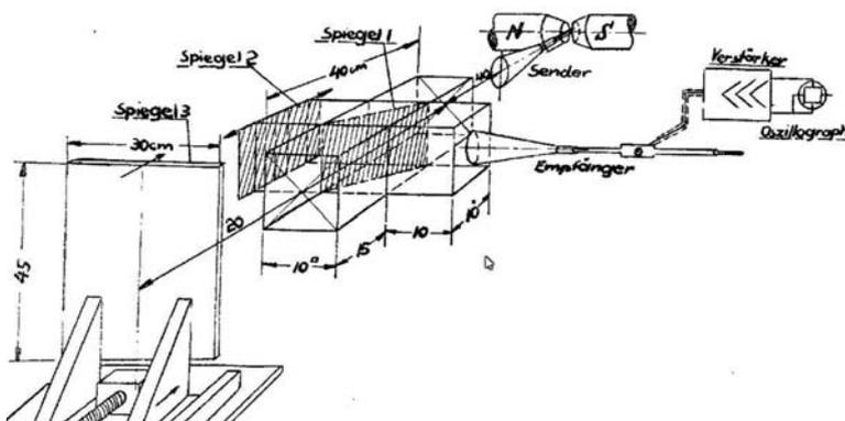
Mobiles Michelson-Interferometer zur Messung im mm-Wellenbereich. Das Interferometer (Bildmitte) ist mit einer metallischen Schutzhülle umgeben. Der Spiegel 2 ist im Gegensatz zum großen Interferometer als Blende mit verschiebbarer Öffnung ausgebildet. Der Messspiegel steht außerhalb der Schutzhülle. Damit wird der Gangunterschied in Luft gemessen. Die Strahlungsquelle ist links im Bild.
