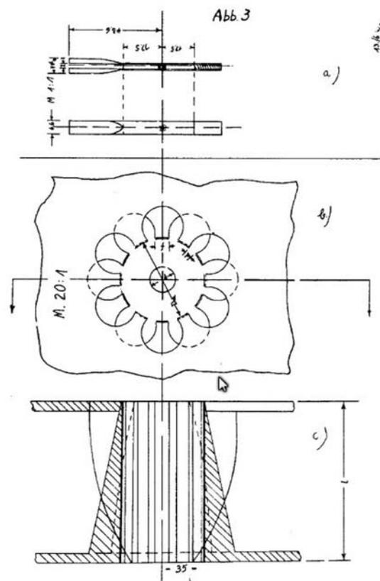
Konstruktionszeichnung des an der PTR entwickelten Magnetrons. (Quelle: CIOS-Bericht XXX-36)
