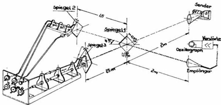
Michelson-Interferometer zur genauen Wellenlängenbestimmung von Mikrowellenstrahlung, aufgebaut in der Aula einer Schule in Zeulenroda. Der Mikrowellenstrahler befindet sich hinten rechts am Fenster, in der Mitte der halbdurchlässige Spiegel, links davon leicht verdeckt ein Metallspiegel, vorn der dritte Metallspiegel, der mit einer Präzisionsspindel messbar zu bewegen ist. Der Horn-Empfänger ist rechts im Bild zu sehen.
