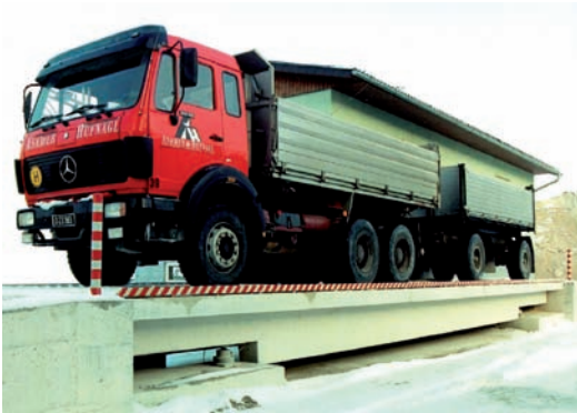
Bild 9: Überflurausführung einer Straßenfahrzeugwaage zur Verwiegung von Lastzügen bis zu 100 t (Werkfoto Schenck Process).
