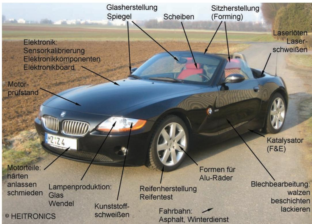
Bild 5: Darstellung einiger Anwendungen der berührungslosen Temperaturmessung bei der Entwicklung, Herstellung und Verarbeitung von Teilen rund ums Automobil.
