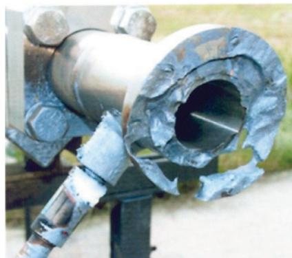
Abbildung 5: Berstscheibenhalter, Ansicht entgegen der Strömungsrichtung
