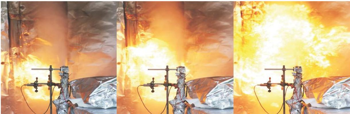
Bild 3: Zündung eines VOC-freien UV-Lacknebels
