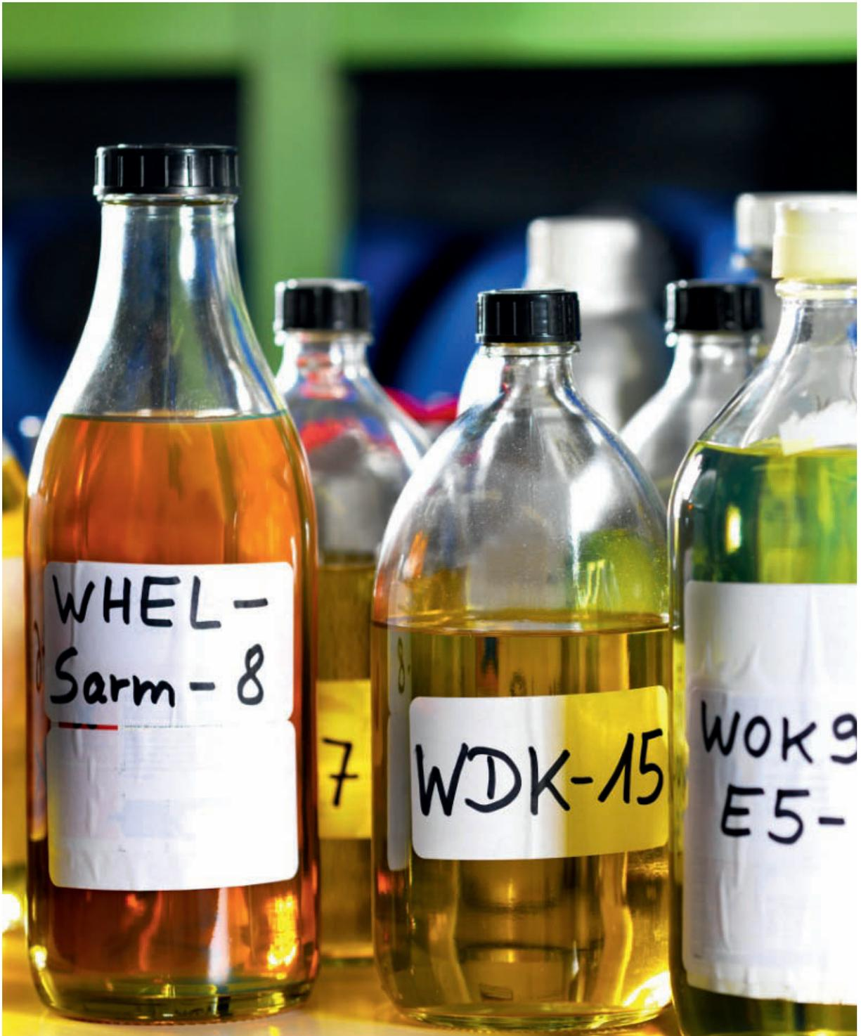
Aus allen Regionen Deutschlands gesammelte Kraftstoffproben zur Messung der Transportgrößen Dichte und Viskosität
