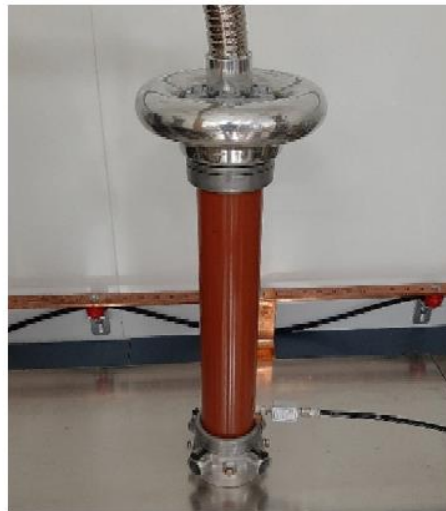
Fig. 14 One 100 kV voltage divider module
