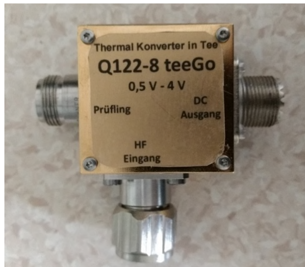
Abbildung 1: Thermischer Konverter in Tee (Eigenbau) mit Quarz PMJTC.
