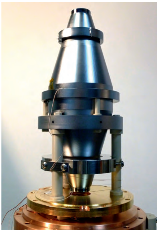
Abbildung 3: Silizium-Resonator und vibrations- unempfindliche Halterung
