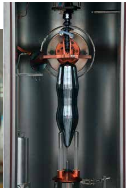
Bild 1: Oben: 4,7 kg schwerer Einkristall aus hochangereichertem 28 Si Links: Nahezu perfekte Kugeln aus 28 Si (mit jeweils einer Masse von 1 kg) Quelle Bild oben: Institut für Kristallzüchtung (IKZ)
