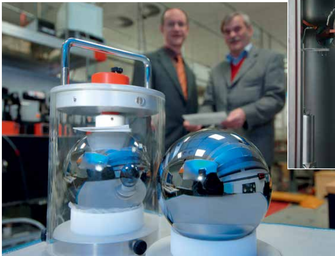
Bild 1: Oben: 4,7 kg schwerer Einkristall aus hochangereichertem 28 Si Links: Nahezu perfekte Kugeln aus 28 Si (mit jeweils einer Masse von 1 kg) Quelle Bild oben: Institut für Kristallzüchtung (IKZ)
