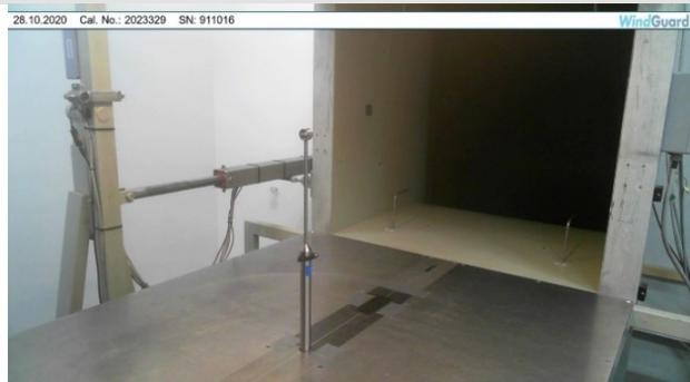
**Abbildung 15:** Messanordnung des DWG-Windkanals WT2
