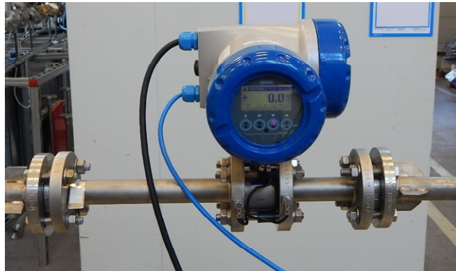
Abbildung 3: Transfergerät #2 - MID DN25, KROHNE
