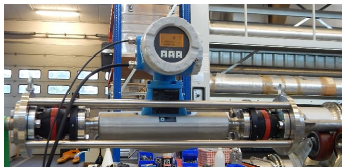
Abbildung 4: Transfergerät #4 - Coriolis DN25
