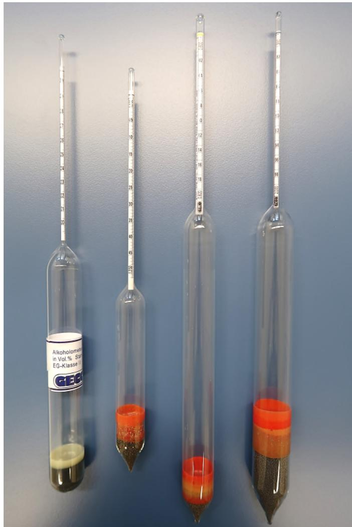
**Abbildung 1:** Aräometer von links nach rechts: 7598 – Alkoholometer; 7113 – mittlerer Dichtebereich; 6833 – niedriger Dichtebereich; 6832 – hoher Dichtebereich
