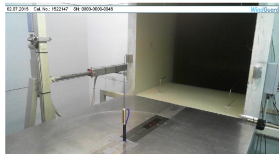
Abbildung A6: Messanordnung des DWG-Windkanals Varel 2
