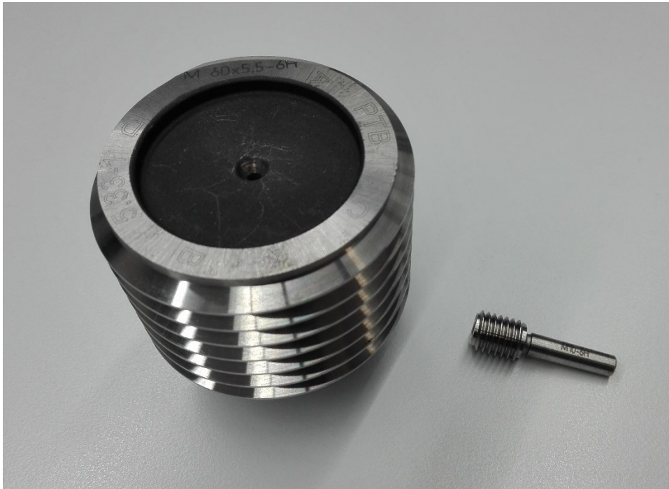
Abbildung 2: Gewindelehrdorne links: M60, rechts: M10
