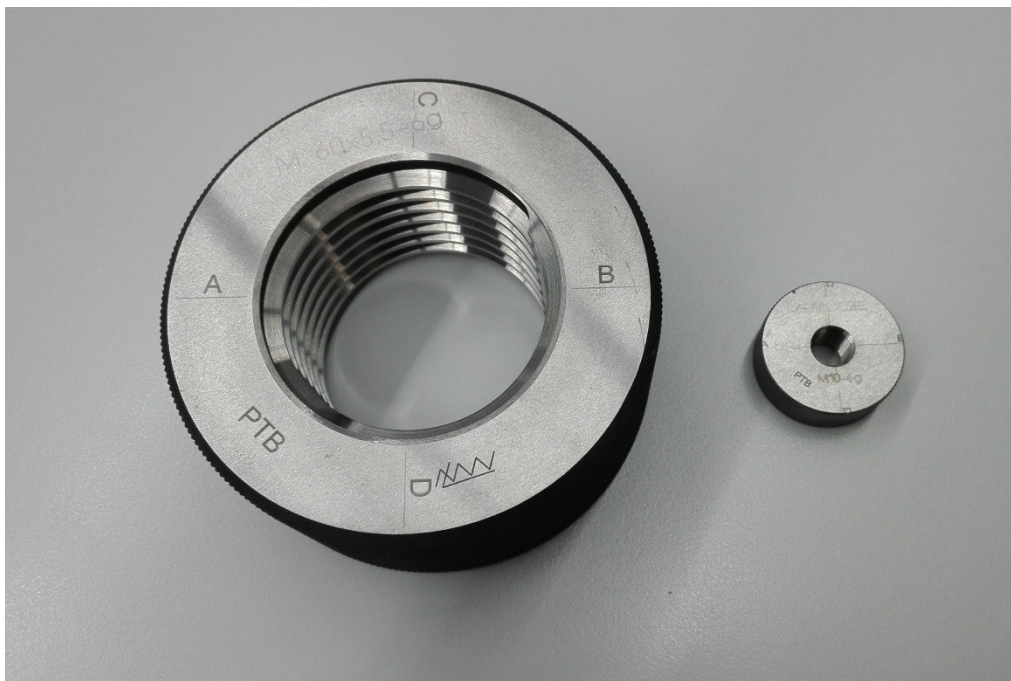
Abbildung 3: Gewindelehrringe links: M60, rechts: M10
