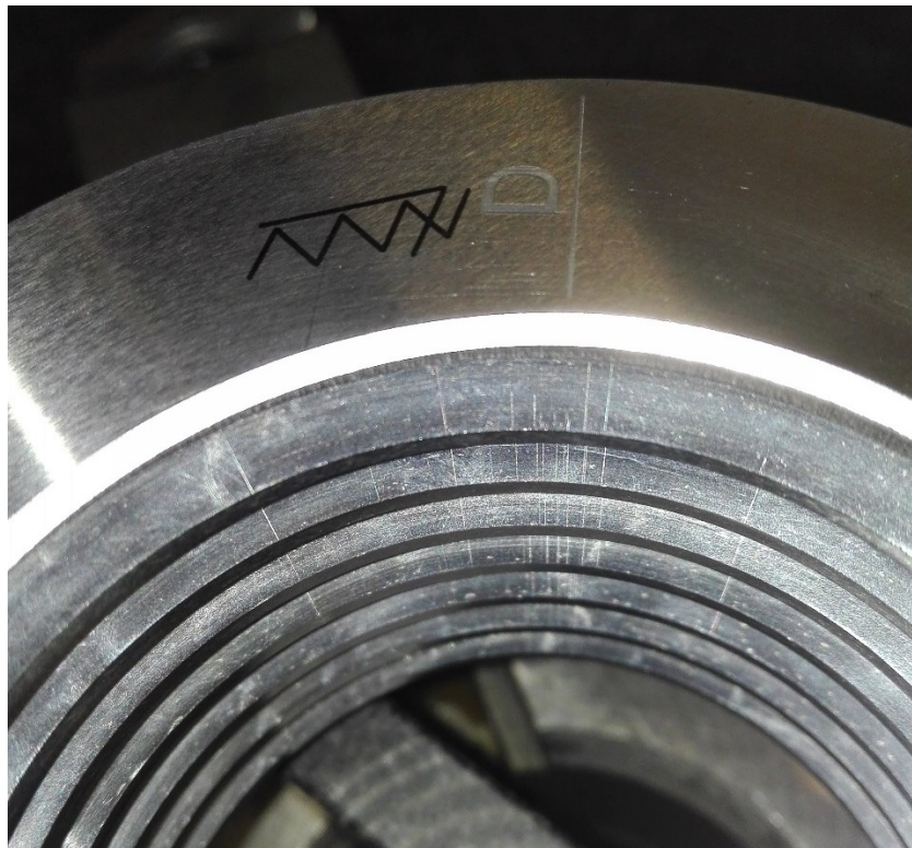
Abbildung 12: Gewindelehring M60 nach Durchführung der Vergleichsmessungen
