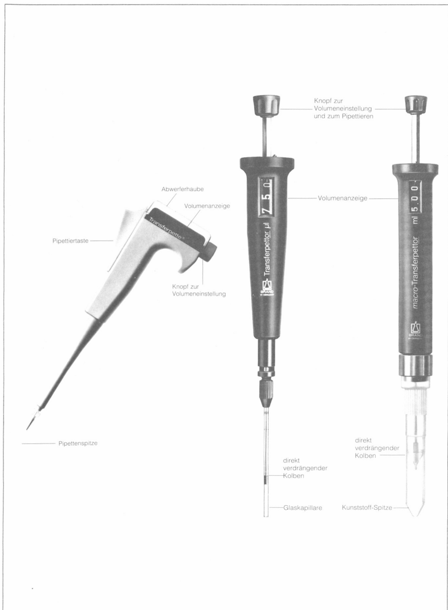
Bild 15: Kolbenhubpipette mit Luftpolster
