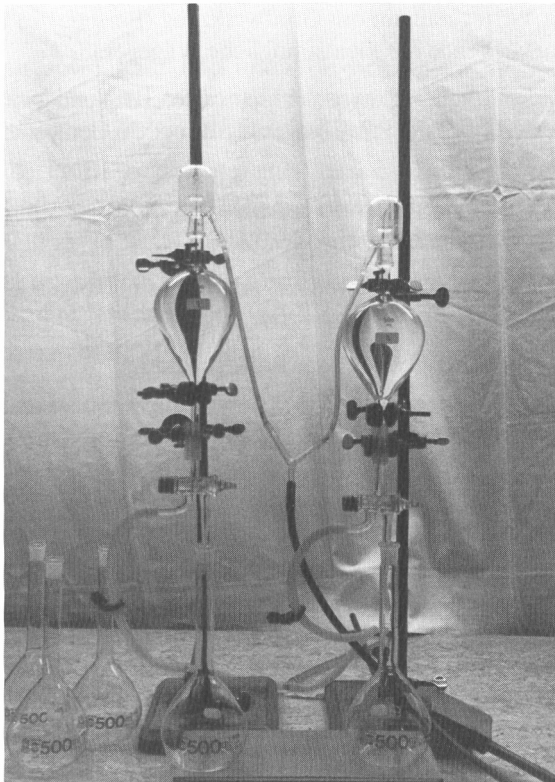
Bild 27: Voluminiereinrichtung zur Prüfung von Meßkolben
