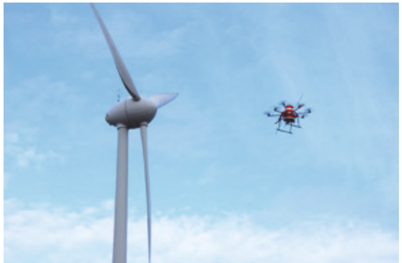
Die fliegende Messplattform der PTB vor einer Windenergieanlage PTB's flying measurement platform in front of a wind turbine
