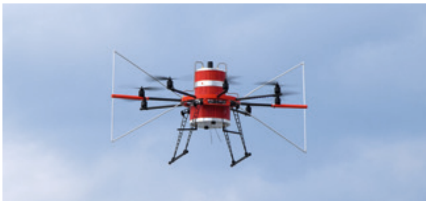
Fliegende Plattform (Oktokopter) zur Vor-Ort-Messung elektromagnetischer Felder Flying platform (octocopter) used for the on-site measurement of electromagnetic fields
