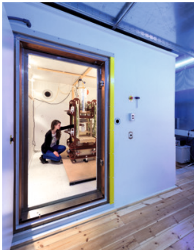
Messung der Kernspinresonanz im Niedrigfeld in einem magnetischen Abschirmraum
