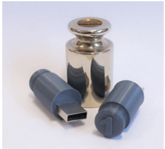
Wägestück mit zugehörigen Digitalen Zwillingen Weight with the associated digital twins
