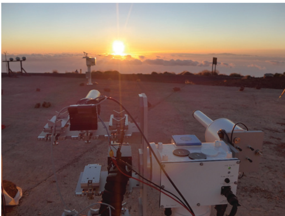
Bild 1: Messung der direkten solaren Bestrahlungsstärke im UV-Spektralbereich am Izaña-Observatorium für Atmosphärenforschung auf Teneriffa im EMRP-Projekt ATMOZ mit Sonnennachführungseinheit und verschiedenen Detektoren
