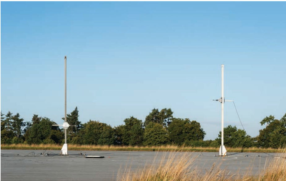
Bild 9: Übertragungsmessung zwischen zwei Antennen auf dem Freifeld der PTB
