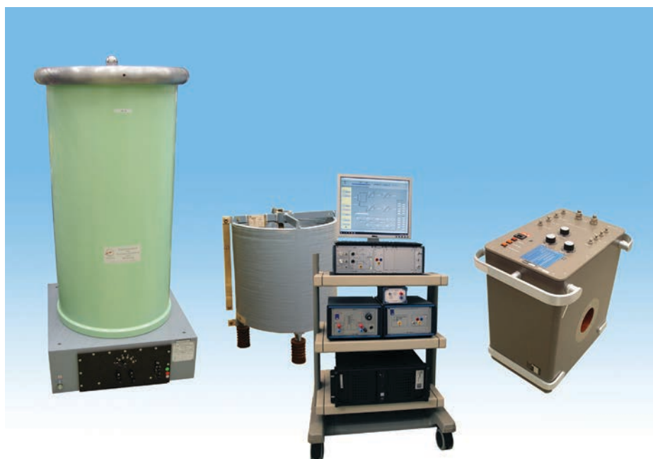
Bild 8: Messsystem zur Bestimmung der Verluste von Blindleistungskomponenten. Hochspannungswandler (links), Stromkomparator (rechts) und selbstentwickeltes Abtastsystem (in der Mitte vorne). Das Messobjekt – eine Strombegrenzungsdrossel für die Mittelspannungsebene – ist im Hintergrund zu sehen.
