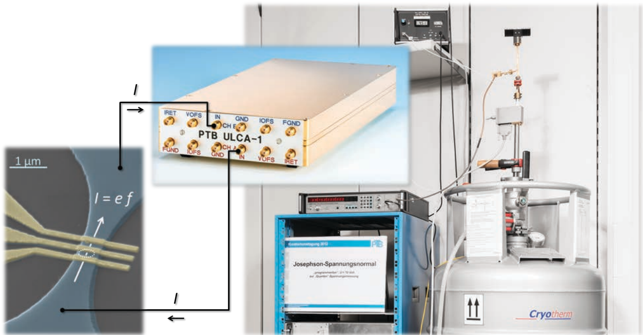
Halbleiter-Einzelelektronenpumpe (links), angeschlossen an einen hochgenauen Strom-Spannungswandler ULCA (Mitte) in Kombination mit einem Josephson-Spannungsnormal zur Spannungsmessung (rechts). Alle Bauteile und Geräte wurden von der PTB entwickelt.
