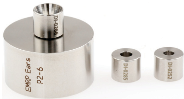
Bild 10: Neugeborenen-Ohrsimulator-Prototyp mit Adaptern zur Ankopplung von Sonden und Einsteckhörern
