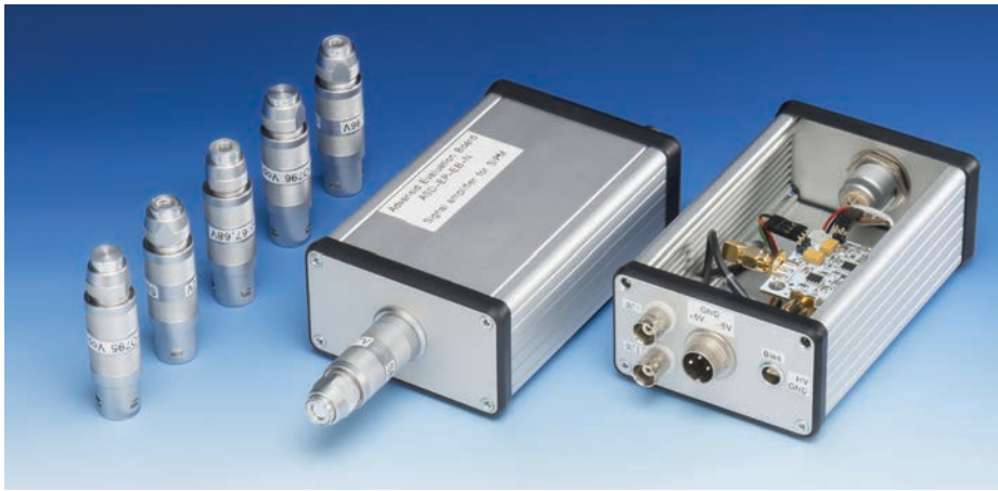
Bild 4. Verstärkerstufe mit der Möglichkeit, verschiedene Detektorvarianten zu charakterisieren
