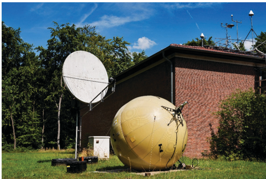
Bild 4: Aufblasbare mobile Zweiweg-Satelliten-Zeit- und-Frequenzübertragungs- (TWSTFT)-Station des US Naval Observatory zur Kalibrierung der Zeitübertragung zwischen der PTB und der GPS Master Clock in Washington DC. Die mobile Station befindet sich neben der Atomuhrenhalle und vor einer festinstallierten TWSTFT-Station der PTB.
