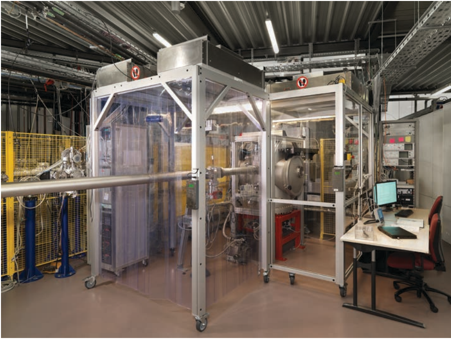
Bild 2: Reinraum mit Vakuumkammer für den Hexapod des neuen Strahlrohres bei BESSY II zur Charakterisierung von Röntgenoptiken in Zusammenarbeit mit der ESA
