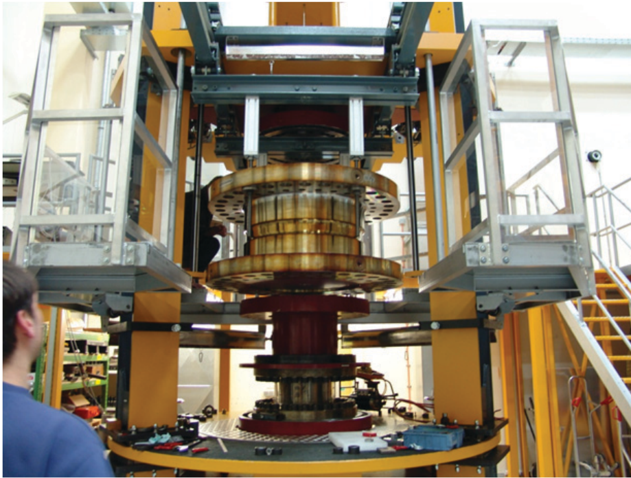
Bild 6: Einbau des 5-MN · m-Drehmomentaufnehmers in die 1,1-MN · m-Drehmoment-Normalmesseinrichtung der PTB.
