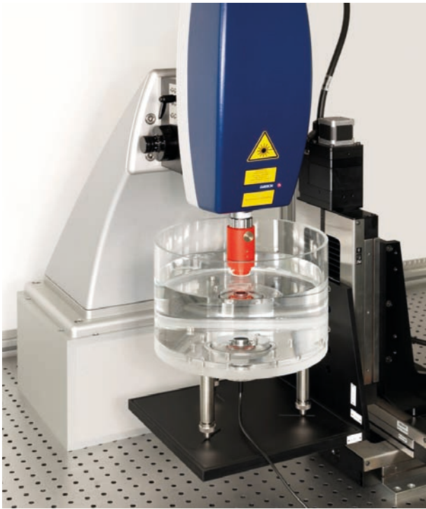
Bild 9: Aufbau zur Ultraschallwechseldruckmessung mithilfe eines UHF-Vibrometers zur Kalibrierung von Hydrophonen
