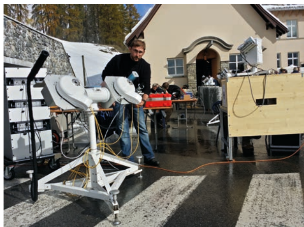
Bild 1: PTB-Mitarbeiter Dirk Friedrich mit verschiedenen Detektoren der PTB, die die Sonnen- und Himmelsstrahlung messen, beim weltweiten Pyrheliometer-Vergleich im Physikalisch-Metrologischen Observatorium Davos (PMOD)
