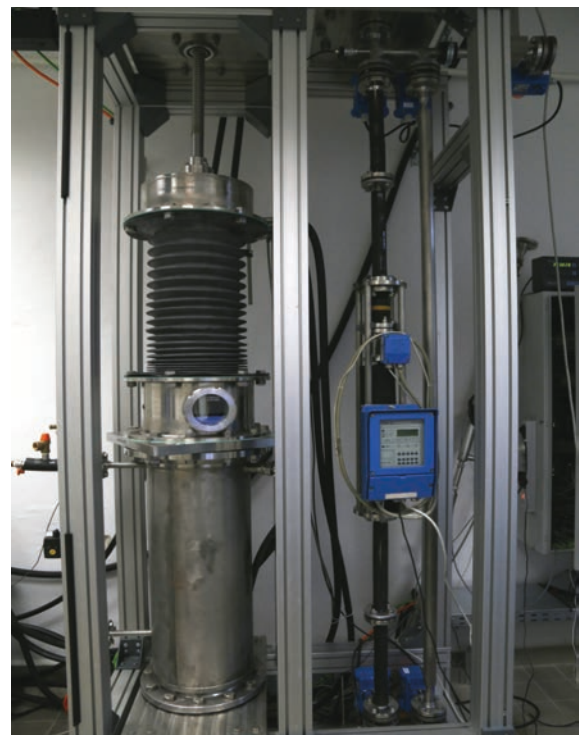
Bild 15: Volumetrischer Prüfstand für messtechnische Untersuchungen an Wärme- und Kältezählern für Solarapplikationen
