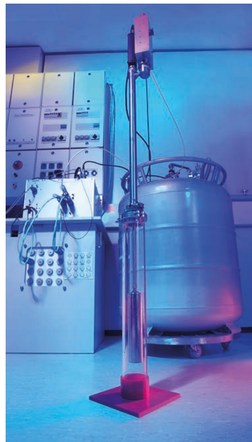
Bild 3: 14-bit-CCC-System für die Kalibrierung hochpräziser Stromverstärker
