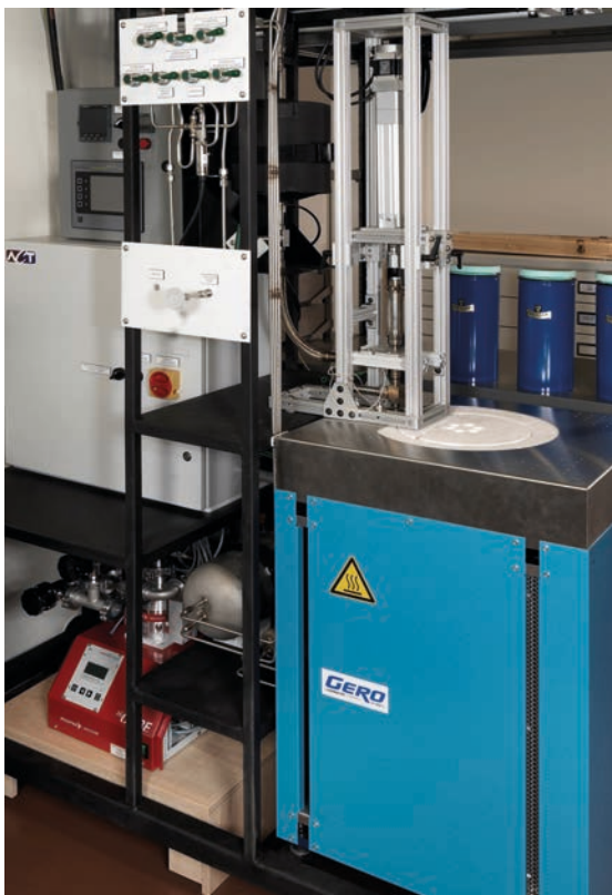
Bild 11: Temperaturhomogener Wärmerohröfen mit in der oberen Bildhälfte erkennbarer Druckreglung
