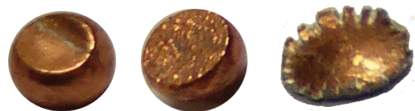
Bild 13: Unterschiedliche Deformationsgrade von typischen Schießbudenprojektilen bei unterschiedlicher Schussenergie (von links nach rechts: 0,6 J; 1 J; 3 J)
