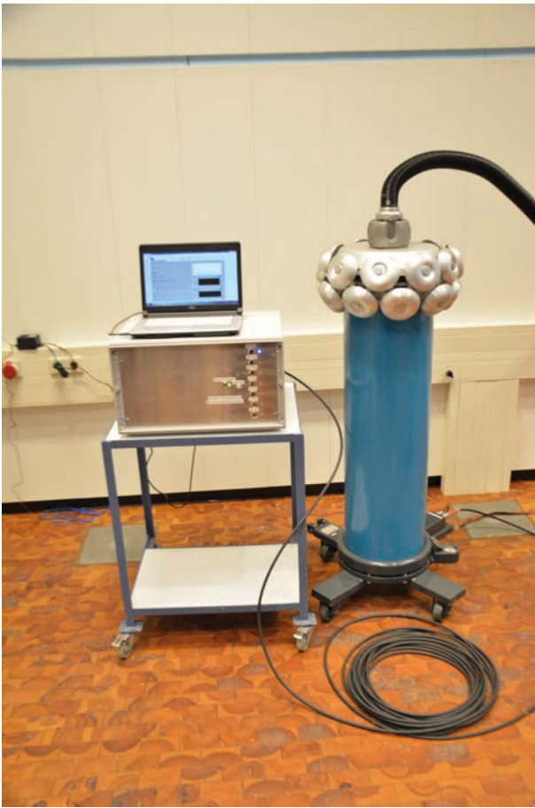
Bild 7: Messsystem für hohe Wechselspannungen bis 800 kV
