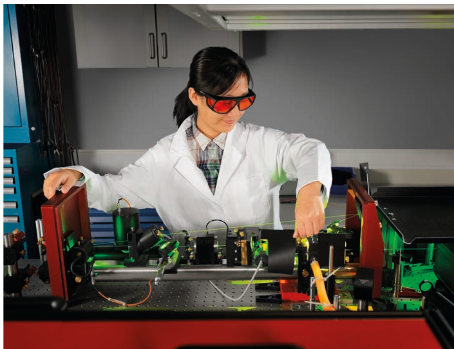
Bild 9: Postdoktorandin Chunyan Shi beim Justieren des Farbstofflasers, der für die nicht-destruktive Moleküldetektion an MgH^+ eingesetzt wurde
