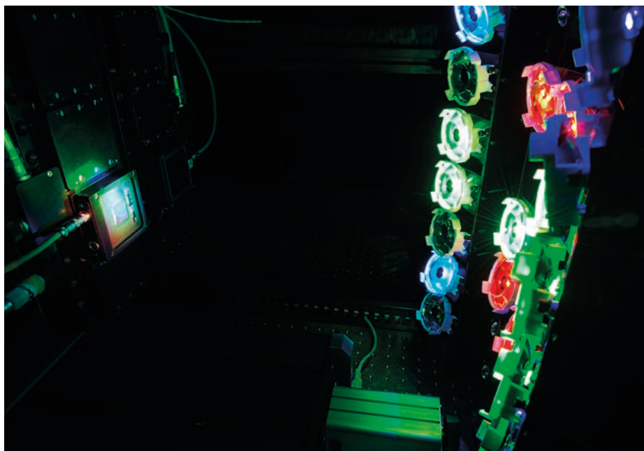
Bild 2: Solarzelle am Kennlinienmessplatz unter simuliertem Sonnenlicht mittels farbiger Leuchtdioden
