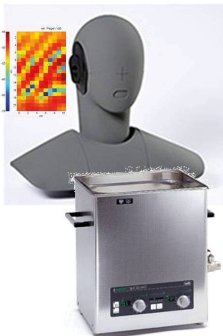
Bild 10: Interferenzen in der Schalldruckverteilung neben dem Ohr eines Kunstkopfes als Simulation eines Benutzers einer Ultraschallreinigungswanne, verursacht durch Reflexionen am Torso (gemessen im Portalscanner)
