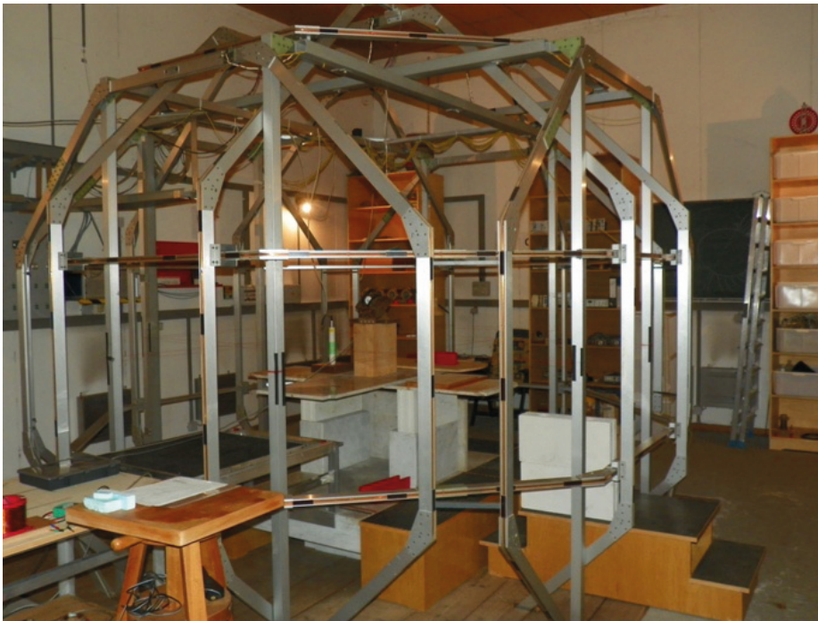
Bild 7: Dreiachsiges Spulensystem nach Braunbek zur Kompensation der drei Komponenten des Erdmagnetfeldes
