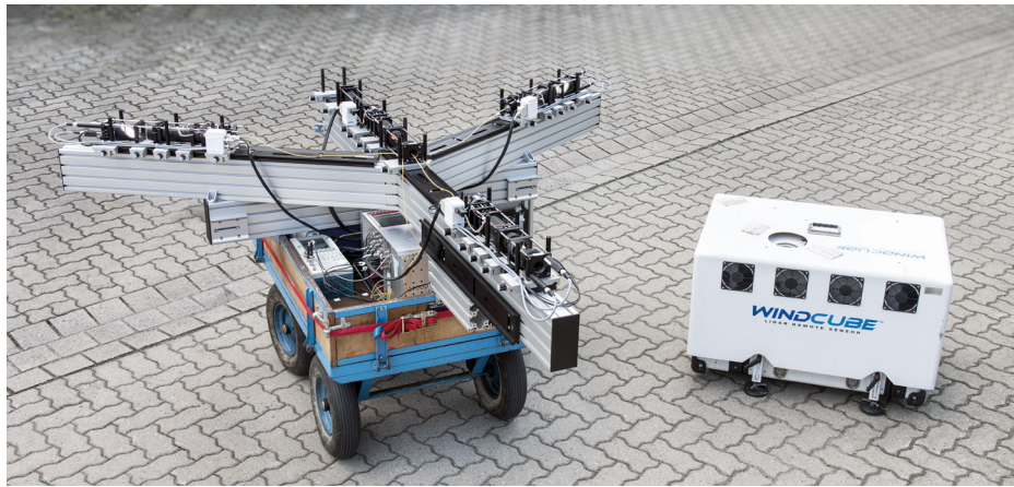
Bild 6: Versuchsaufbau des bistatischen Transfer-Wind-Lidar-Systems (links) und kommerziell erhältliches, monostatisches WindCube-Lidar (rechts)
