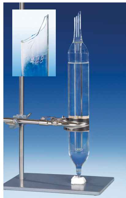
Bild 8: Im Jahr 1928 in der Physikalisch-Technischen Reichsanstalt von Helmut Moser hergestellte, heute noch funktionsfähige Wasser-Tripelpunktzelle
