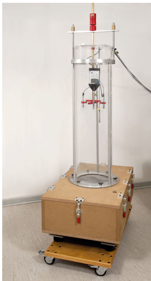
Bild 9: Zylindrische Messkammer zur Kalibrierung im Frequenzbereich 1 Hz bis 50 Hz
