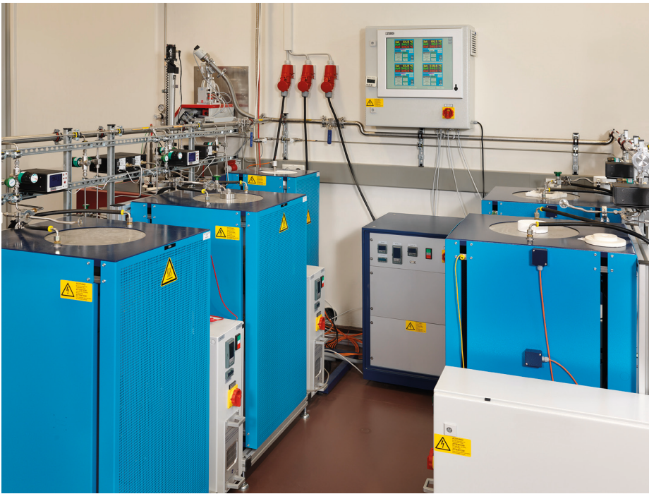
Bild 7: Isotherme Wärmerohrthermostate mit zentraler Steuerung und Reinstgasversorgung zum Betrieb der als nationale Temperaturnormale verwendeten Fixpunktzellen
