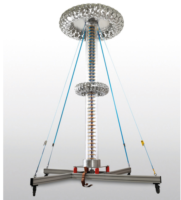
Bild 8: Prototyp eines gedämpft-kapazitiven 1000-kV-Stoßspannungsteilers
