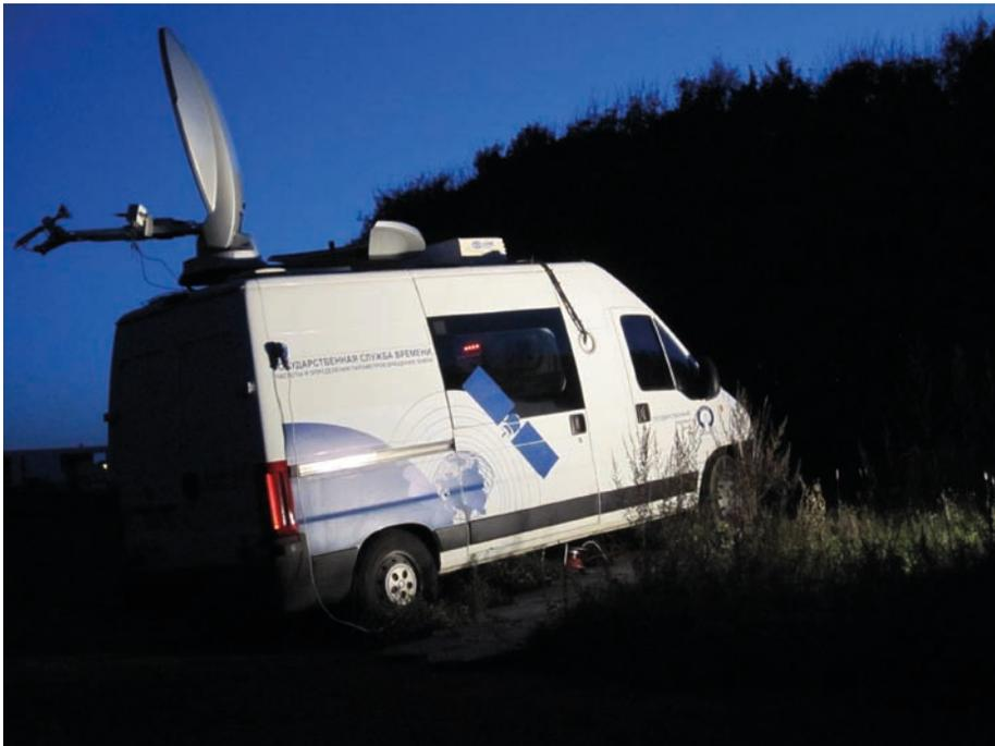
Bild 7: Mobile Zweiweg-Messeinrichtung des russischen Instituts VNI-IFTRI mit transportablen Sende- und Empfangseinrichtungen zur Kalibrierung der Zeitübertragung über geostationäre Satelliten bei einer Messkampagne mit der PTB
