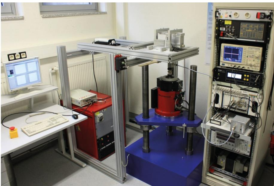
Bild 5: Ansicht der neuen dynamischen Drehmoment-Normalmeseinrichtung der PTB bis 20 N · m und 1 kHz
