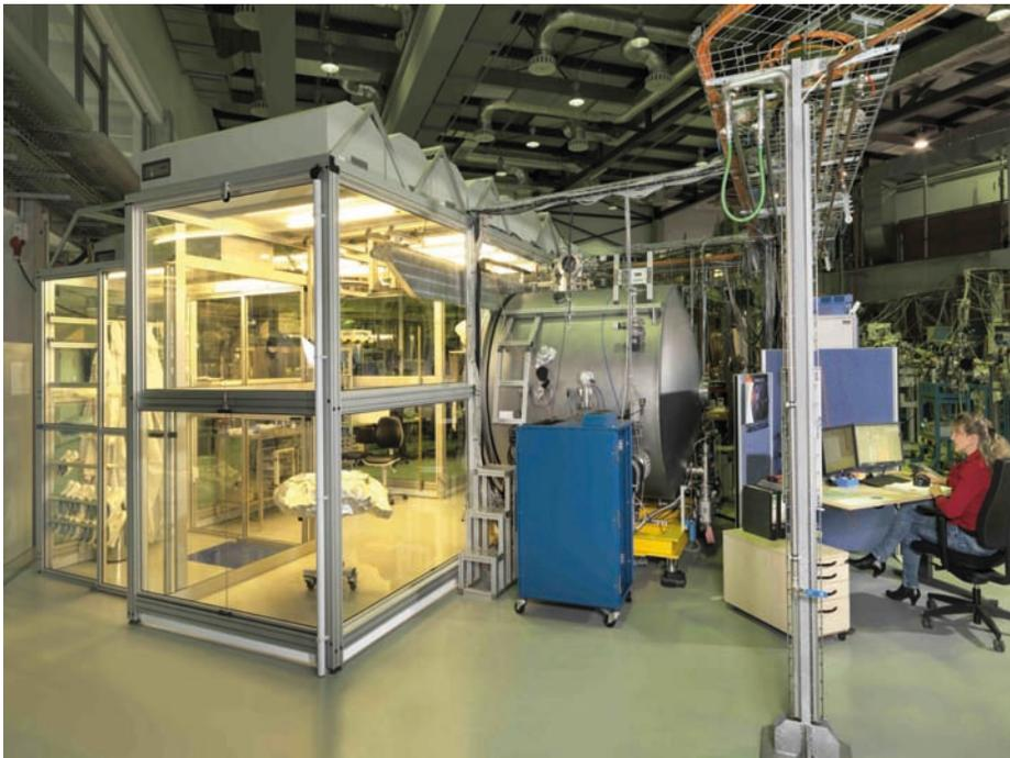
Bild 1: Das EUV-Reflektometer der PTB am EUV-Strahlrohr der MLS
