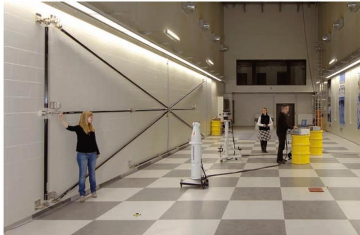
Bild 5: a) (links) Prinzipbild eines Lasertrackers; b) (rechts) Referenzwand der PTB für die Prüfung der messtechnischen Eigenschaften von mobilen 3D-Koordinatenmessgeräten, wie z. B. Lasertrackern
