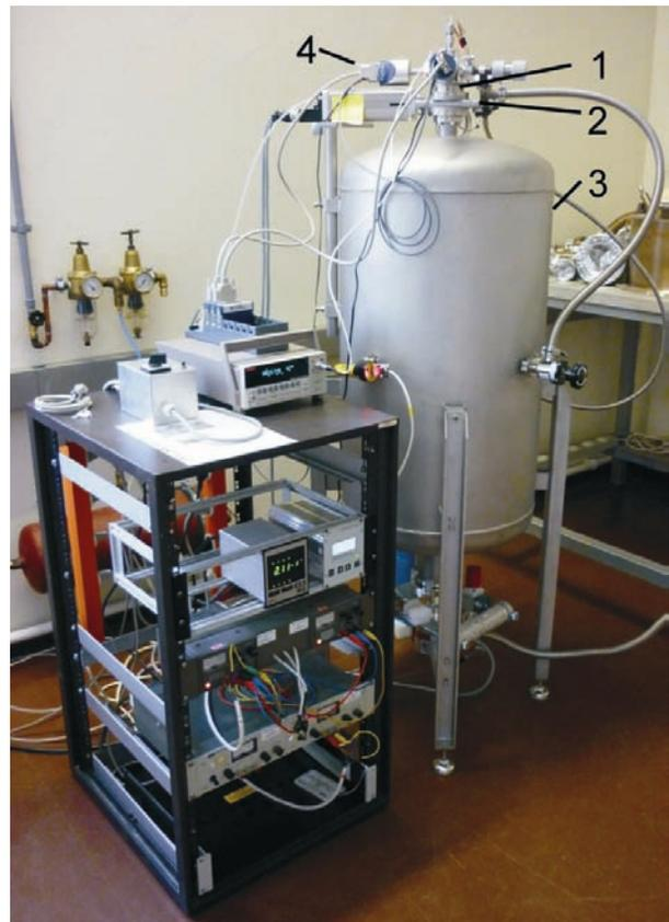
Bild 9: Das neue dynamische Vakuumnormal. Durch die Gasexpansion aus einem sehr kleinen (1) in ein sehr großes Volumen (3) mittels eines sich schnell öffnenden Schieberventils (2) kann der Druck im kleinen Volumen innerhalb 20 ms um 3 Größenordnungen abgesenkt werden und die Antwortzeit eines Vakuummeters (4) untersucht werden.
