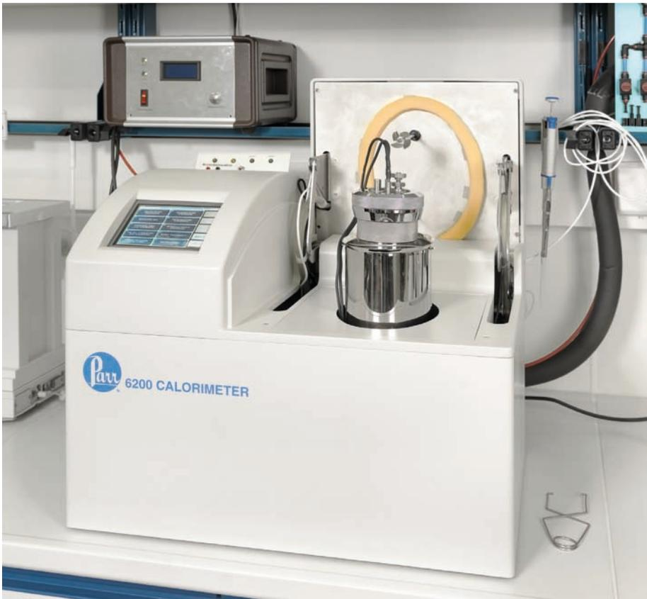
Bild 9: Bombenkalorimeter zur Messung des Brennwertes von flüssigen Kraftstoffen
