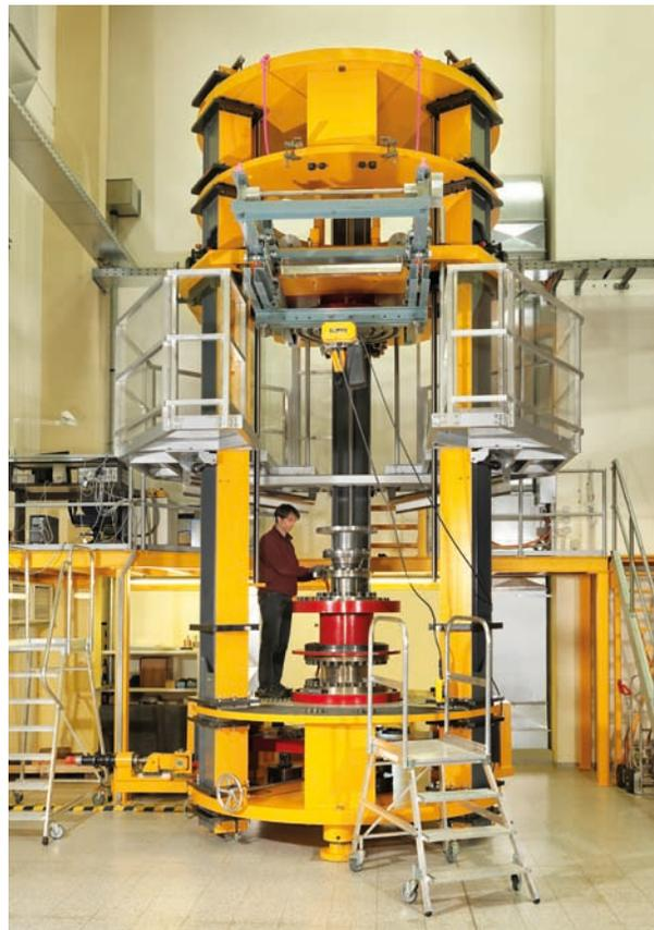
Bild 2: 1,1-MN · m-Drehmoment-Kalibriereinrichtung nach der Umsetzung
