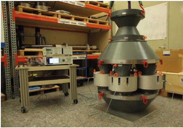
Bild 1: 50-MN- Build-Up-System zur rückgeführten Messung sehr großer Kräfte
