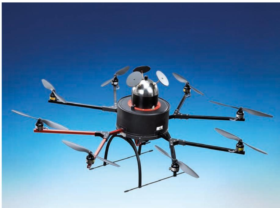
Abbildung 7: Oktokopter mit Messantennen zur Bestimmung der Feldstärke „vor Ort“, z. B. in der Nähe von Windenergieanlagen
