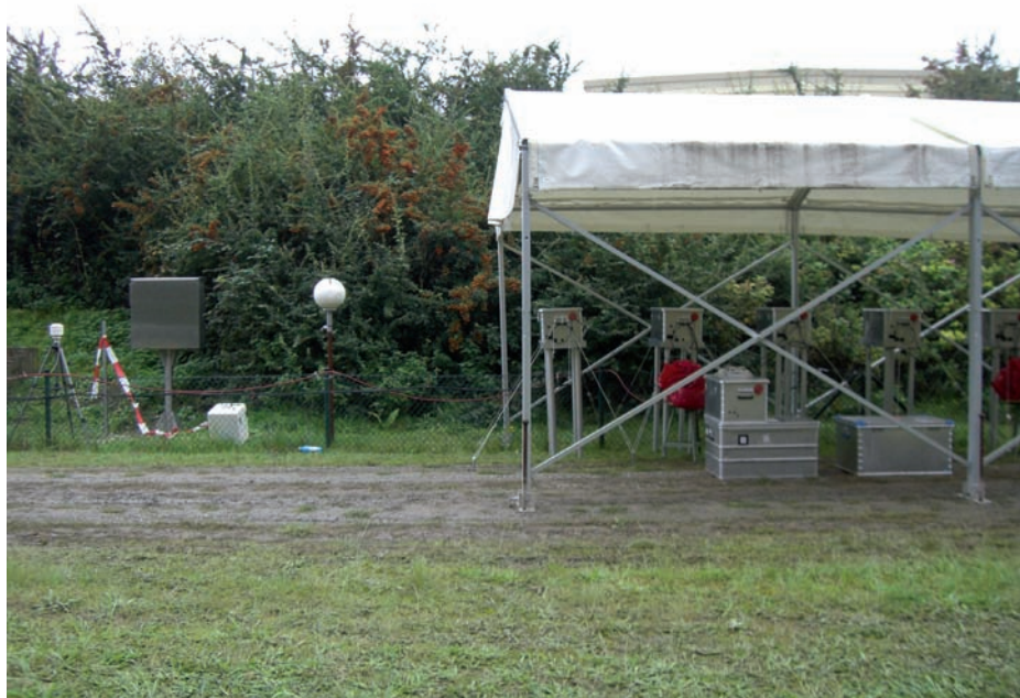
Bild 7: Messaufbau am Betriebsgeländezaun des TBL. Auf der linken Seite sieht man die amtliche Neutronendosis-Messstelle (weiße Kugel), unter dem Zelt die in Aluminiumkisten befindlichen Detektoren des NEMUS Spektrometers. Hinter dem Erdwall ist das Dach der TBL Halle zu erkennen.
