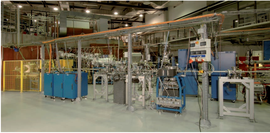
Bild 1: EUV-Strahlrohr an der MLS: Direkt an der Strahlenschutzmauer (links) befindet sich der Plangittermonochromator, im Abstand von 6 m folgt der Austrittsspalt, der von einem weiteren Spiegel auf den Messpunkt am zukünftigen Standort des EUV-Reflektometers (rechts vom Bildrand) abgebildet wird.
