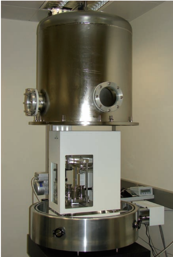
Bild 1: 10-kg-Massekomparator AX10005 im neuen, druckstabilen Gehäuse (hier geöffnet)
