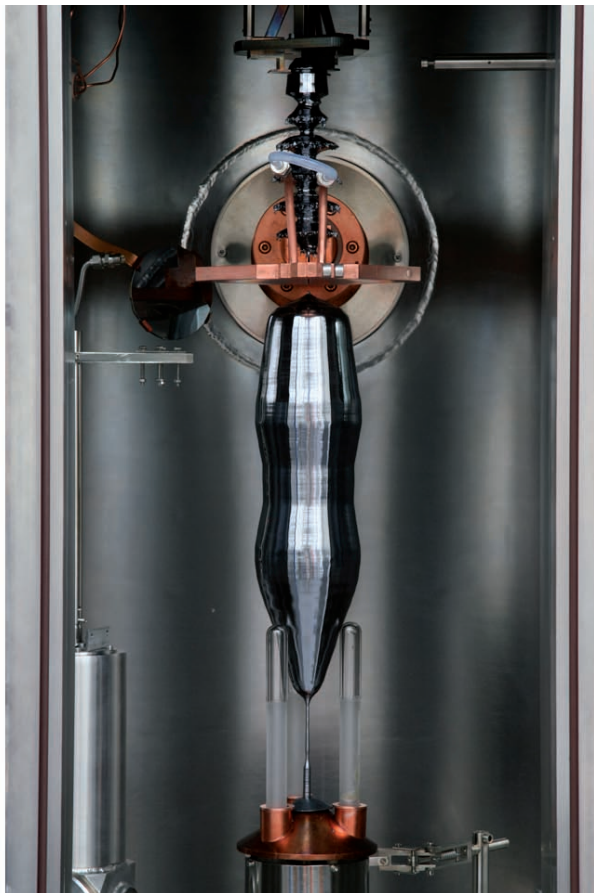
Bild 2: Einkristall aus Isotopen-angereichertem Silizium.
