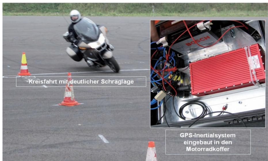
Bild 10: Testfahrt mit einem Polizei-Motorrad zur Analyse des Einflusses der Schräglage auf Geschwindigkeitsmessungen mit Videonachfahrssystemen.
