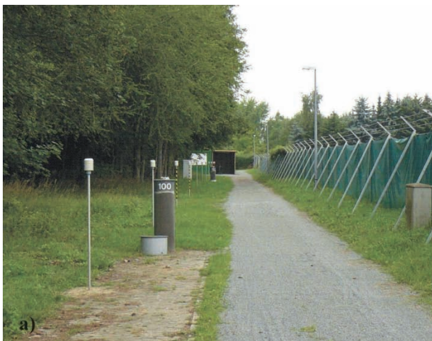
Bild 5: Ausgebaute 600 m Pfeilerstrecke der PTB. a) Sicht auf die Messstrecke. Im Hintergrund ist das Außenlabor zu sehen. Der mit undurchsichtiger grüner Folie behangene Zaun dient dem Laserschutz. b) Exemplarischer Verlauf der effektiven Temperatur und der effektiven relativen Feuchte über die gesamten 600 m während eines Tages. Die grauen Bänder geben die Standardabweichungen der einzelnen Sensoren vom Mittelwert an.
