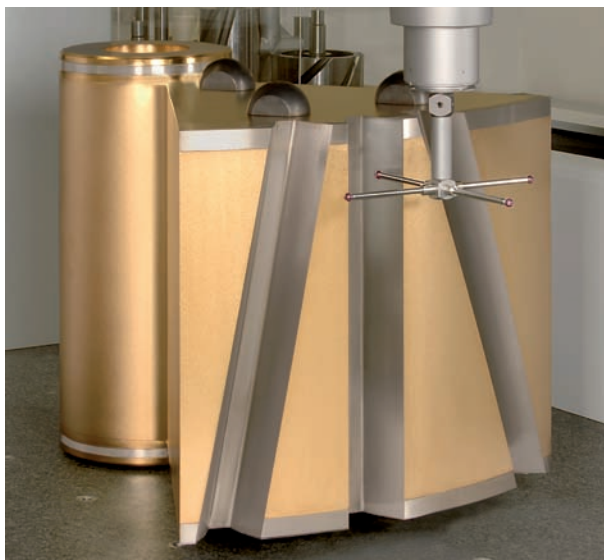
Bild 1: Nur ein Segment – und doch repräsentiert das neue Normal drei unterschiedliche, komplette Zahnräder von je einem Meter Durchmesser.
