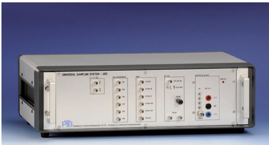
Bild 7: Vielseitig verwendbares dreiphasiges Abtastsystem. Das Messgerät ermöglicht Messungen von Spannungen und der elektrischen Leistung mit Messunsicherheiten von einigen mV/V, mrad oder mW/VA bei Netzfrequenzen.
