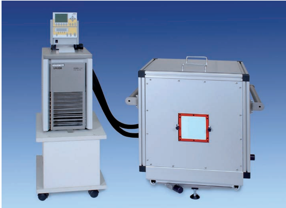
Bild 1: Transportables Wasserkalorimeter (rechts) mit zugehörigem Kühlaggregat (links). Die Strahlung trifft horizontal auf das Strahleintrittsfenster des Kalorimeters (rot umrandet). Die Kantenlänge des fast quaderförmigen Kalorimeters beträgt ca. 60 cm.
