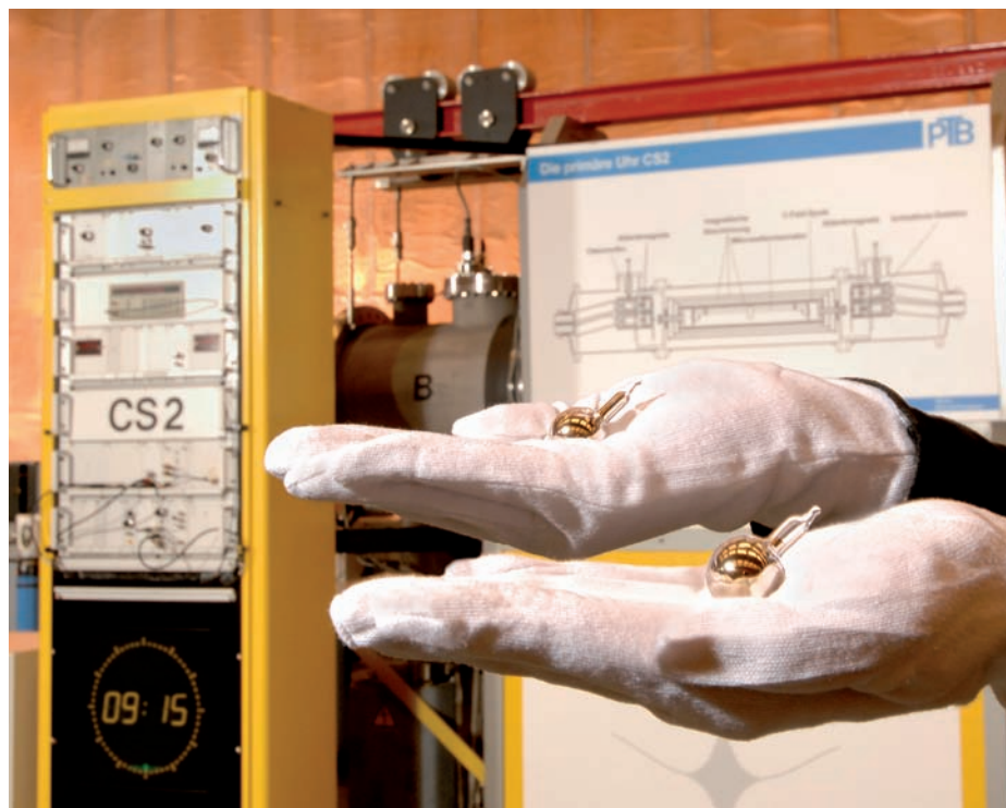
Bild 7: CS2 tickt wieder, nachdem nach 24-jährigem Betrieb der Caesiumvorrat von zwei Ampullen mit je 5 g Caesium-133 in den beiden Atomstrahlöfen der Uhr aufgefüllt worden war.
