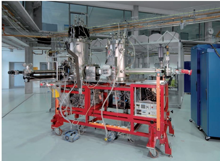
Bild 5: Kryoradiometer SYRES II, das als primäres Empfängernormal für das UV und Vakuum-UV an der MLS eingesetzt wird
