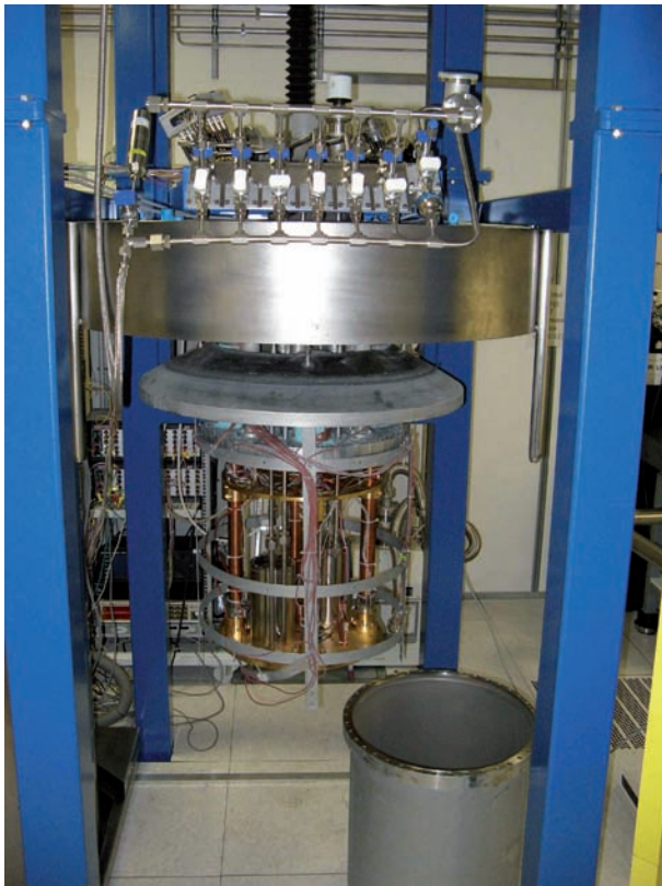
Bild 6: Blick auf den geöffneten Thermostaten des DCGT mit den Mess- und Gasversorgungssystemen
