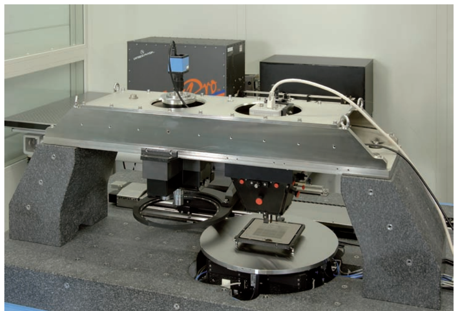
Bild 6: Aufbau des 193-nm-Mikroskops der PTB
