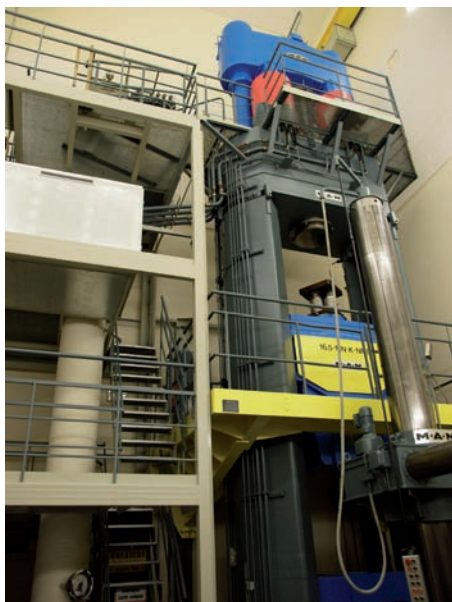
Bild 3: Ansicht der 16,5-MN-Kraft-Normalmess-einrichtung (links) und Visualisierung der neuen SPS-Steuerung (rechts)
