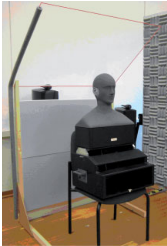
Bild 8: Transparenter Schallschutzschirm für Orchestermusiker mit schallabsorbierender Verkleidung. Durch die Verwendung bei Beschallung von hinten (schwarze Lautsprecherboxen) werden vor dem Schirm Schallpegelminderungen von bis zu 20 dB erreicht.
