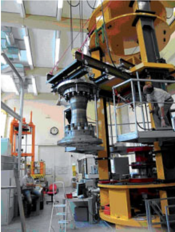
Bild 4: 1,1-MN-m-Drehmoment-Messeinrichtung mit Bestückungsvorrichtung.
