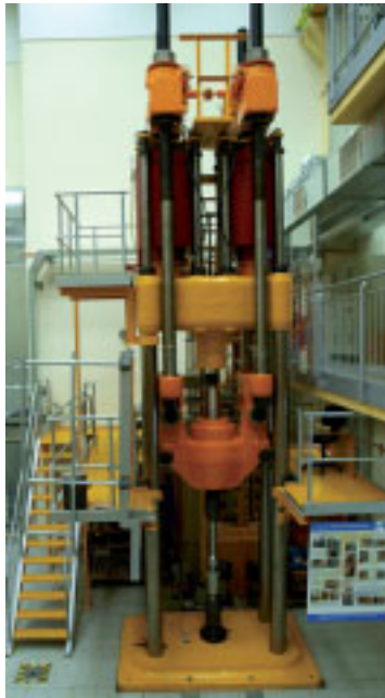
Bild 2: Hydraulische 5-MN-K-NME mit gleichzeitig montiertem Zug- und Druckkraftaufnehmer
