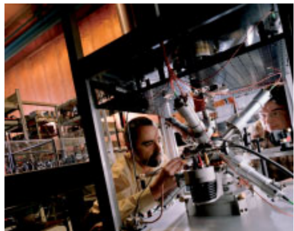
Bild 5: In der neuen Fontänenuhr der PTB werden die Caesiumatome im Kreuzungspunkt von sechs Laserstrahlen gekühlt, bevor sie zur Anregung und Abfrage nach oben beschleunigt werden.
