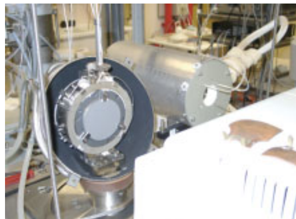
Bild 5: Apparatur zur Bestimmung des Emissionsgrades unter Atmosphäre bei Temperaturen bis 450 °C.
