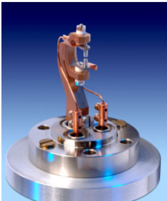
Bild 6: Die neue Ionenfalle der PTB. Bei dieser so genannten Endkappenfalle wird das Ion im freien Spalt zwischen den im oberen Bildteil sichtbaren konzentrisch aufgebauten Elektroden gehalten.
