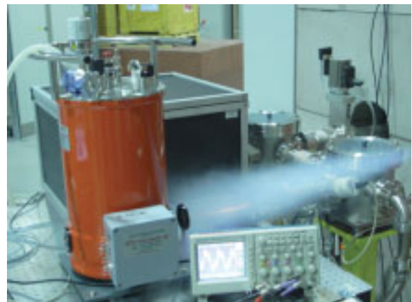
Bild 7: Infrarot-Strahlrohr an der Metrology Light Source.
