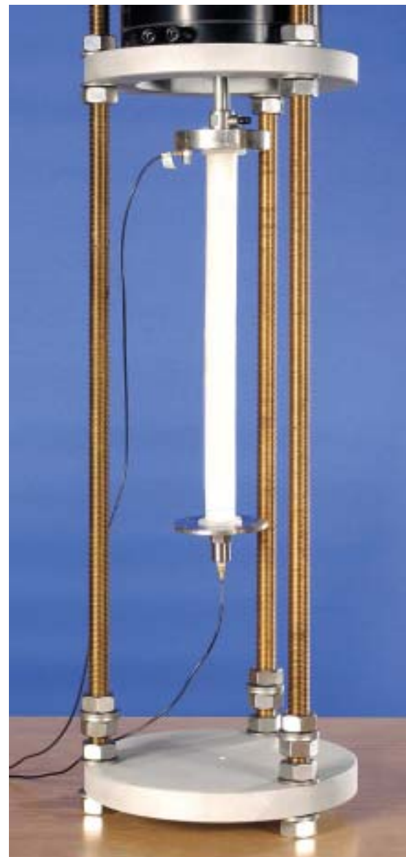
Bild 8: Versuchsaufbau zur Bestimmung des komplexen Elastizitätsmoduls von Silikon im Frequenzbereich von 10 Hz bis 600 Hz bestehend aus einem elektrodynamischen Schwingerreger (ganz oben), der Silikonprobe (weißer Stab in der Mitte) und zwei piezoelektrischen Beschleunigungsaufnehmern mit Anschlusskabeln (an den Enden des weißen Stabes).
