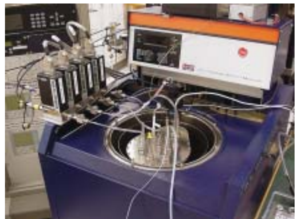
Bild 2: Isoperiboles Präzisionskalorimeter zur Brennwertbestimmung von Erdgasen (Gesamtansicht)
