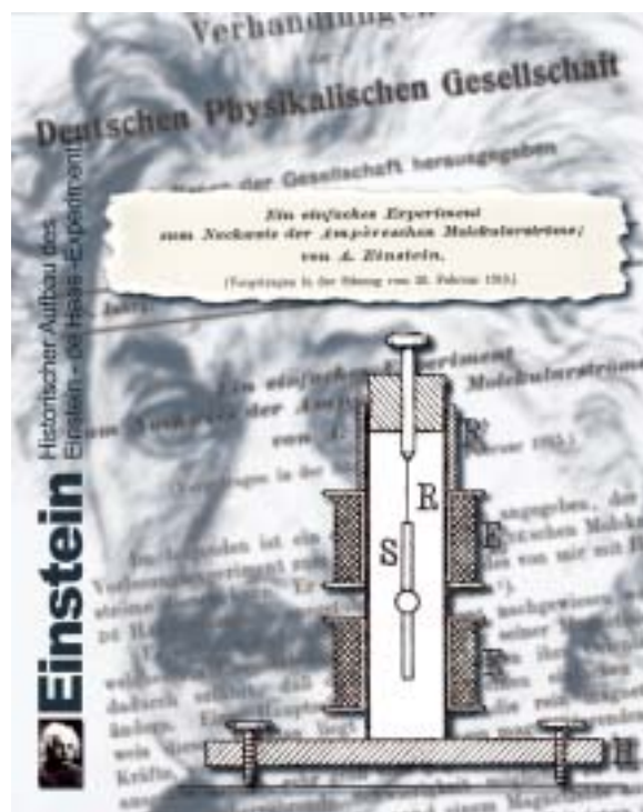
Bild 1: Von Einstein skizzierter Aufbau für den Einstein-de-Haas-Versuch aus der Originalarbeit
