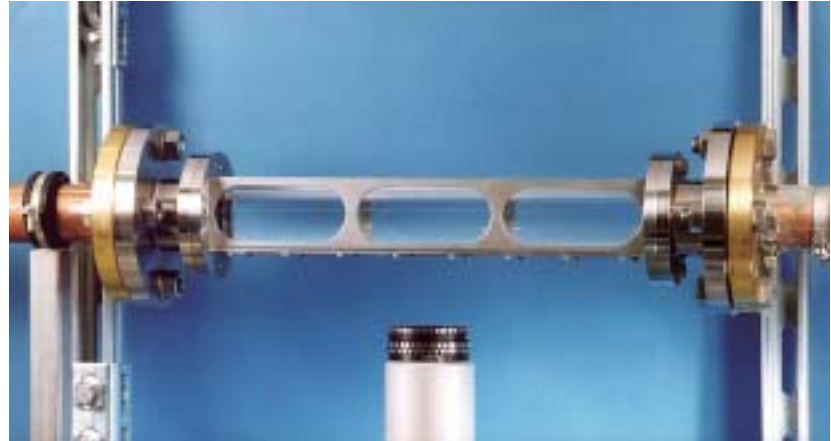
Bild 6: Messanordnung zur Untersuchung von Geschwindigkeitsprofilen, bestehend aus einem Rohrpassstück in 50 mm Nennweite mit brechzahl- und konturangepassten Fenstern und dem LDA-Messkopf
