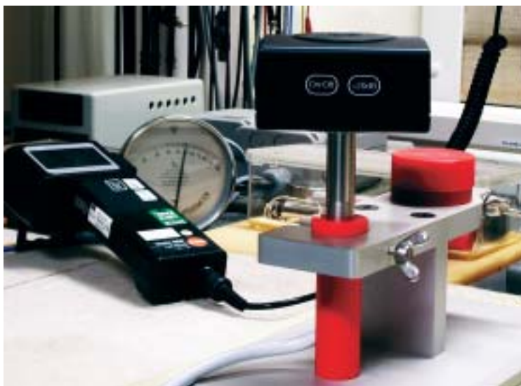
Bild 7: Schallkalibrator (schwarze Box, rechts im Vordergrund), der auf ein Referenzmikrofon (silberner, senkrechter Zylinder, rechts im Vordergrund) aufgesteckt wurde
