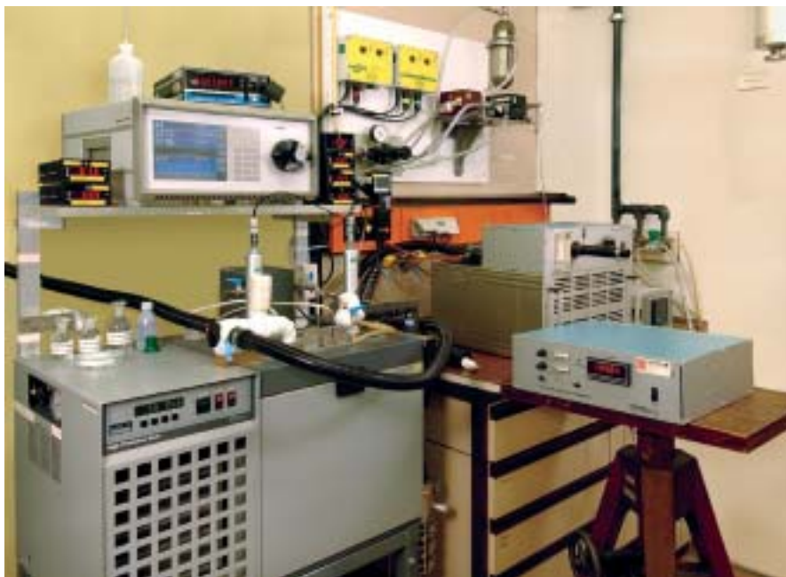
Bild 4: Feuchtegenerator im Bereich von -20\text{ °C} bis +60\text{ °C} Taupunkt zur Rückführung von Feuchtemessgeräten
