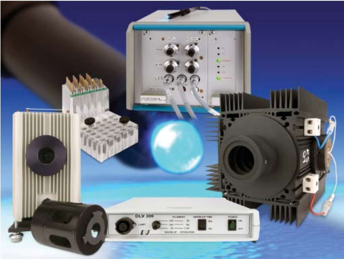
Bild 8: Drei in der PTB entwickelte Strahlersysteme, die jetzt von Firmen zum Einsatz als Normale vertrieben werden: Kalibrierstrahler für Feldeinsätze (rechts), Deuteriumlampensystem für UV-Messungen (links unten) und Leuchtdioden-Transfornormal für photometrische Größen (links oben)
