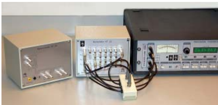
Bild1: Kalibrierung einer Wechselspannungs-Temperaturmessbrücke mit dem neuen PTB-Brückennormal (links im Bild ist der Referenzteiler zu sehen, mit dem das Brückennormal „in-sich“ kalibriert wird)
