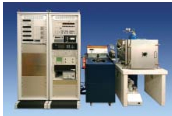
Bild 3: Dieses isoperibole Präzisionskalorimeter zur Brennwertbestimmung von Erdgasen soll als Referenzgerät für die europäische Gasindustrie eingesetzt werden.
