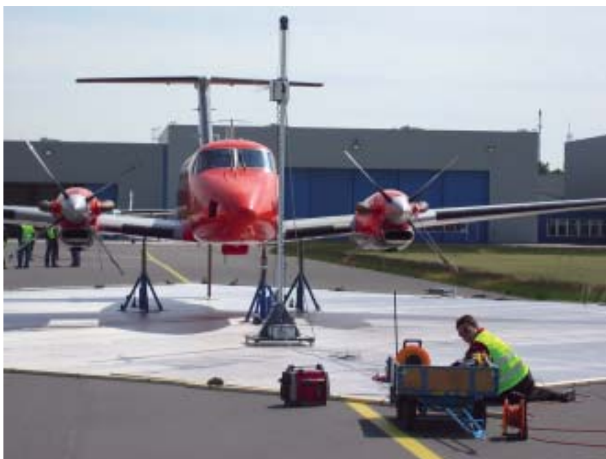
Bild 2: Messtechnische Validierung der Antennendiagramme an einem Messflugzeug
