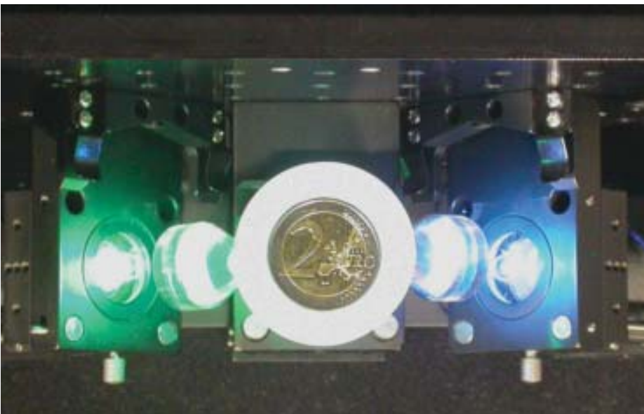
Bild 6: Prototyp einer Messeinrichtung zur Prüfung reflektierender Oberflächen
