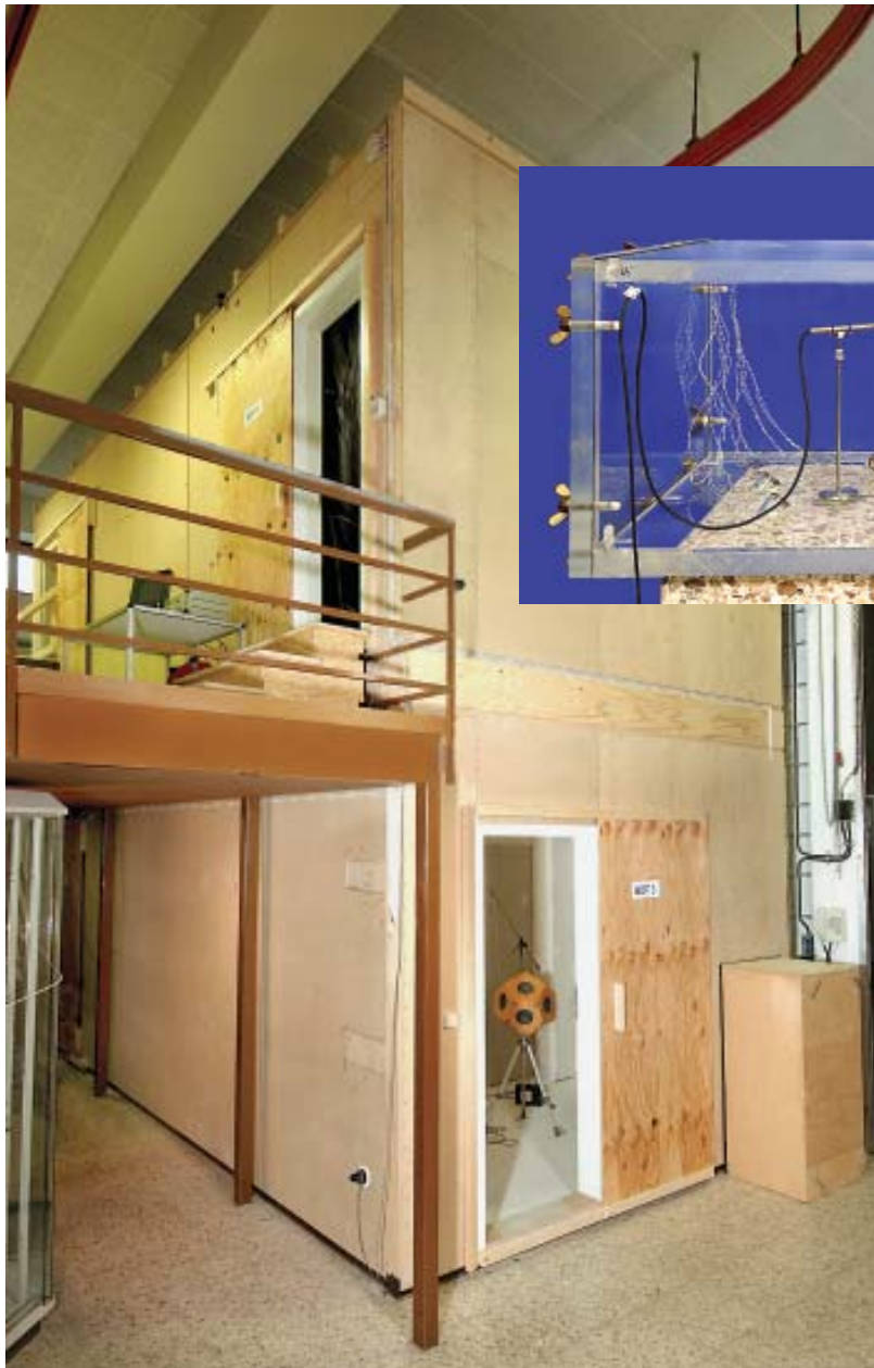
Bild 10: Leichtbau-Prüfstand zur Bestimmung der von sanitären Anlagen verursachten Geräusche
