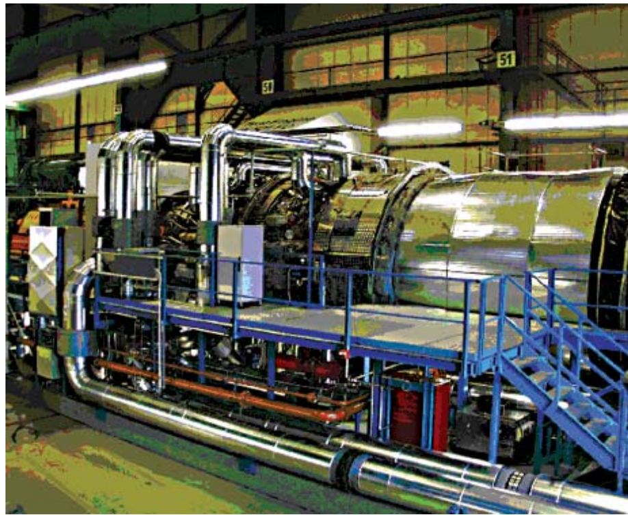
Bild 2: Siemens-Gasturbine, für die eine Messwelle mit der 1,1\text{-MN} \cdot \text{m} -Drehmoment-NME kalibriert wurde
