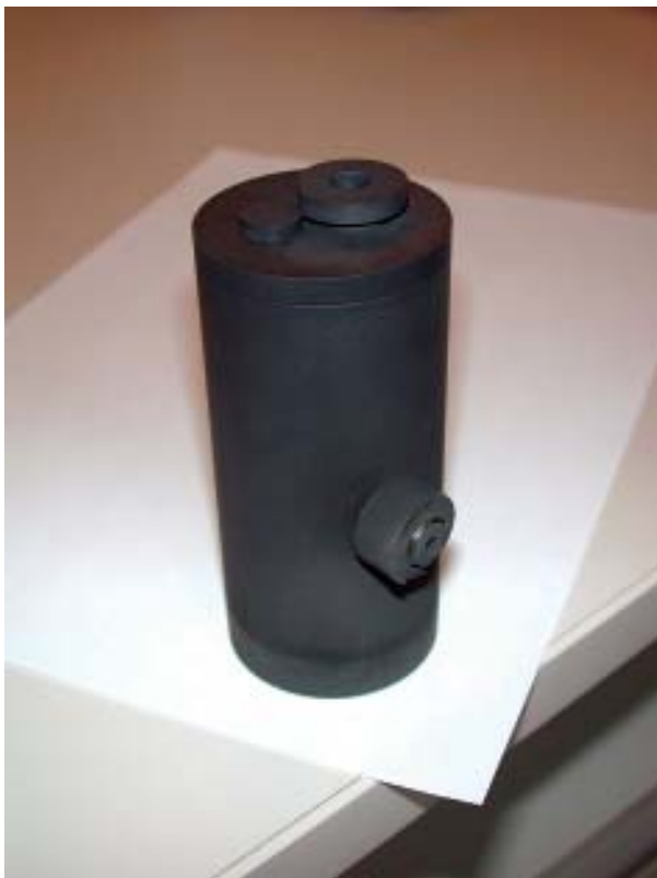
Bild 9: Hochtemperatur-Fixpunktzelle für den Vergleich von Berührungs- und Strahlungsthermometern
