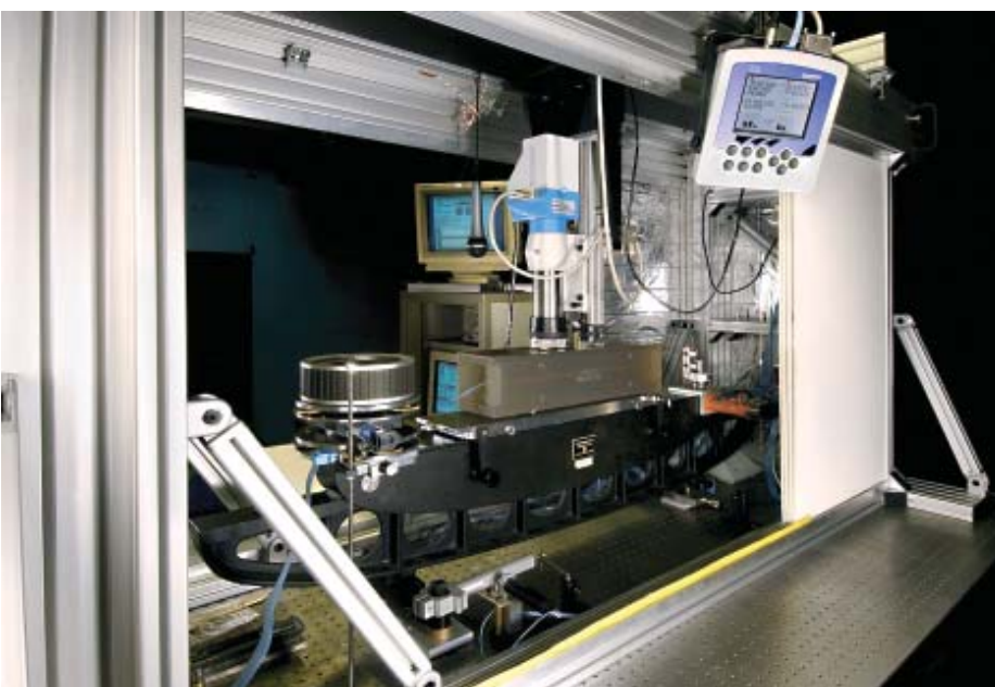
Bild 3: Messeinrichtung zur Charakterisierung von Ebenheitsnormalen
