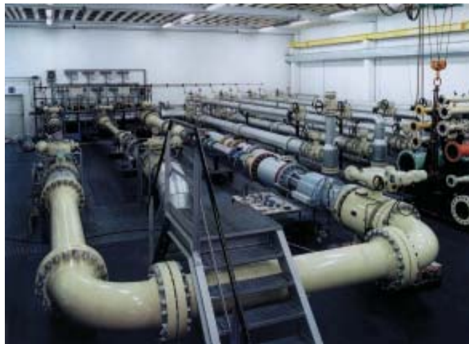
Das nationale Normal der Bundesrepublik Deutschland für die Durchflussmessung von Erdgas (Quelle: Ruhrgas AG)
