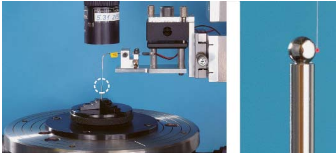
Bild 8: Messanordnung zur Formmessung mit dem taktil-optischen Taster rechts: im linken Bild markiertes Detail (Messbeispiel: Messung der Rundheit einer Kugel mit 1 mm Durchmesser)
