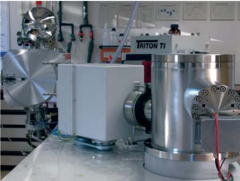
Bild 2: Thermionen-Massenspektrometer für die Elementanalytik
