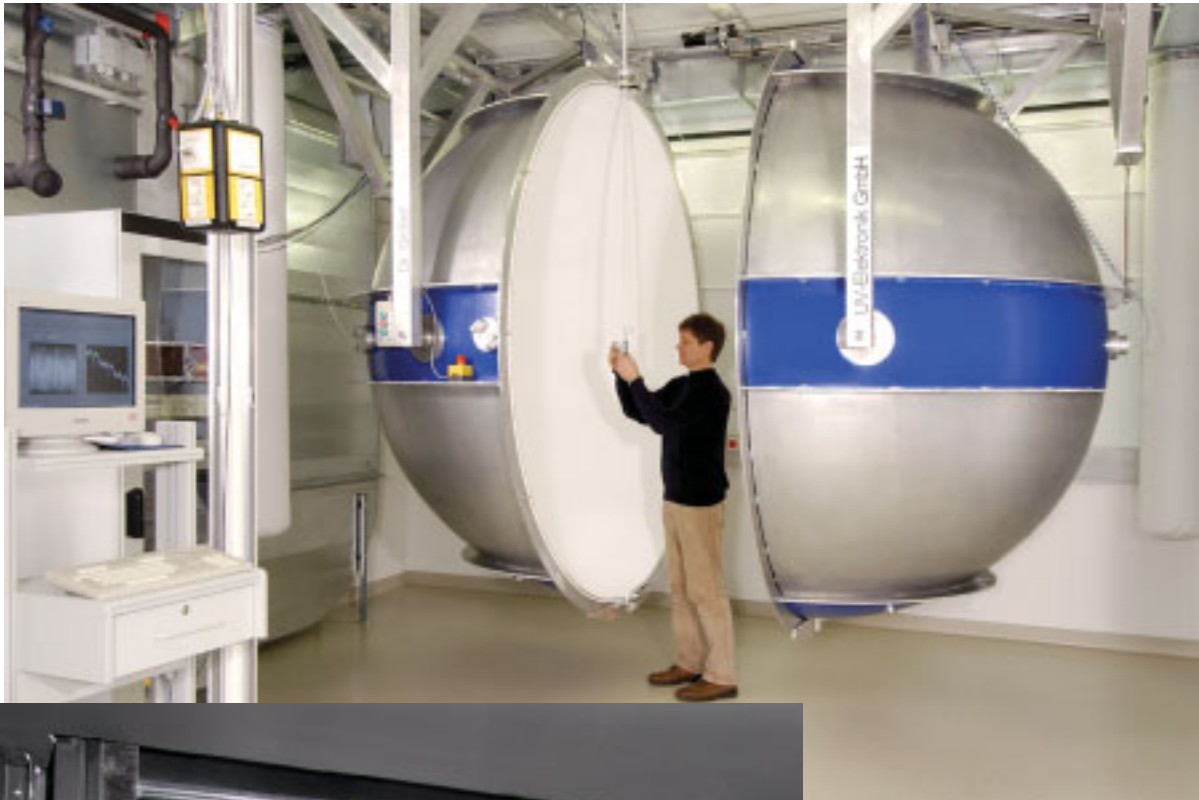
Bild 1: Die neue integrierende Kugel im Albert-Einstein-Bau erlaubt mit moderner Messtechnik eine verringerte Bestimmung der Messunsicherheit des Lichtstroms neuartiger Lichtquellen.
