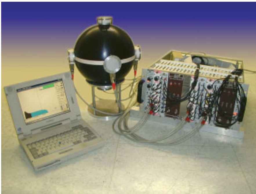
Bild 4: Spektrometer zur Messung der Energie- und Richtungsverteilung von Neutronen in gemischten Neutronen-Photonen-Strahlungsfeldern an Arbeitsplätzen der Kernindustrie
