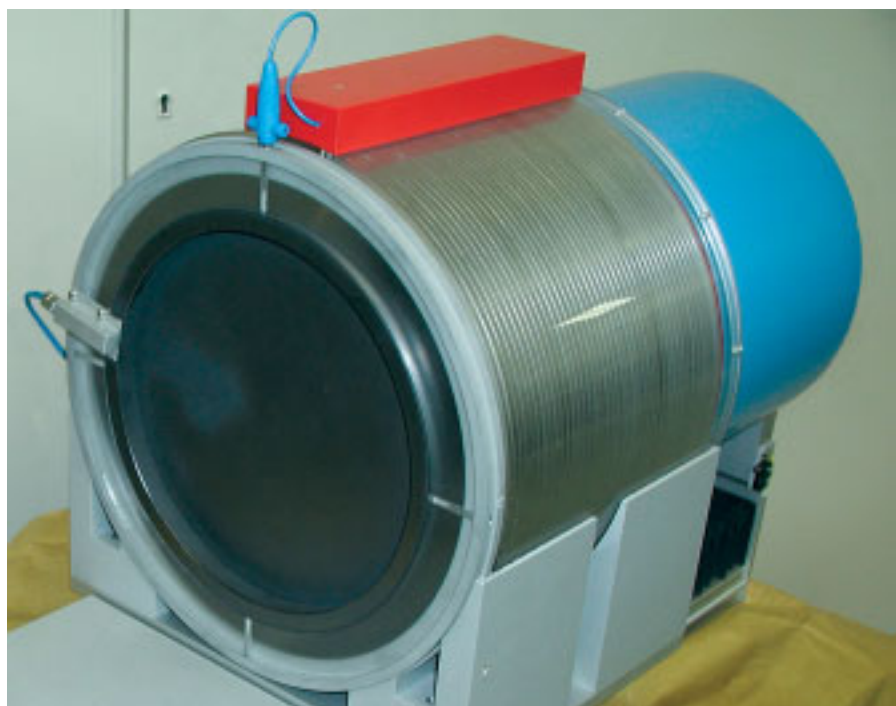
Bild 1: Neue großvolumige Extrapolationskammer zur Kalibrierung von niederenergetischen Brachytherapie-Quellen mit geringer Dosisleistung
