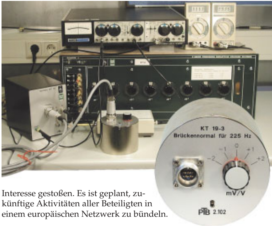
Bild 1: Kalibrierung des neu entwickelten Kalibriernormals gegen Referenzteiler der PTB
