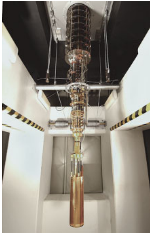
Bild 6: Neuartige konzentrische Dreifach-Kernentmagnetisierungsstufe zum Test montiert in der Tieftemperaturanlage MKA 3
