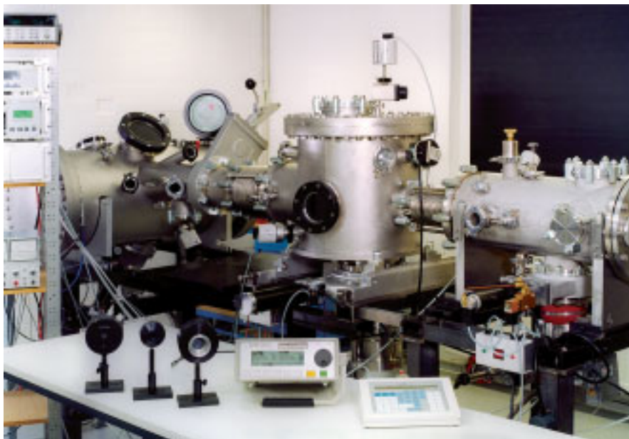
Bild 3: Messplatz für die Kalibrierung von Detektoren bei 157 nm
