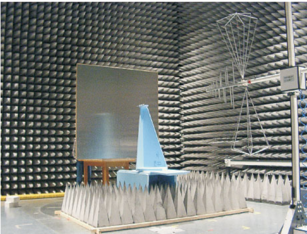
Bild 5: Apparatur zur rückführbaren Kalibrierung von Magnetfeld-Transfersensoren in einem Wellenfeld
