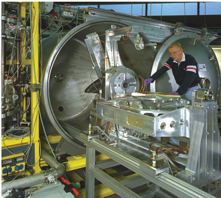
Bild 1: Aufbau des neuen EUV-Reflektometers für große Spiegel im Radiometrielaboratorium der PTB bei BESSY II
