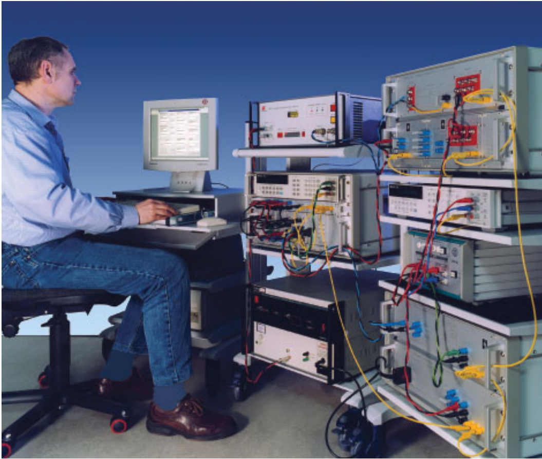
Bild 4: Neues digitales PTB-Normal für die elektrische Wechselleistung
