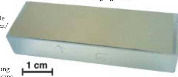
Bild 2: Schichtdicken-Maßverkörperung mit C-Ni-C- bzw. Ni-Schichtsystemen auf Quarzsubstrat, Anwendungsbereich: Röntgenreflektometrie
