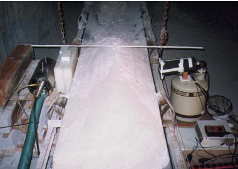
Bild 1: Gamma-Spektroskopie untertage im Bergwerk Neuhofer-Ellers von der Firma „Kali und Salz“. Auf der linken Seite befindet sich der Neutronengenerator (Polyethylen zur Moderation der Neutronen), in der Mitte das Transportband mit dem Salz und rechts der HP-Ge-Detektor mit Elektronik.
