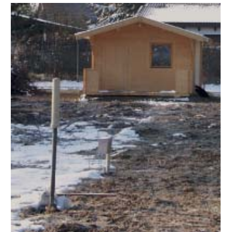
Bild 3: Inbetriebnahme des Freiluft-Referenzmessplatzes zur Bestimmung der einzelnen Komponenten der Umgebungsstrahlung. Vorne links IMIS-Messsonde, hinten Messhütte.
