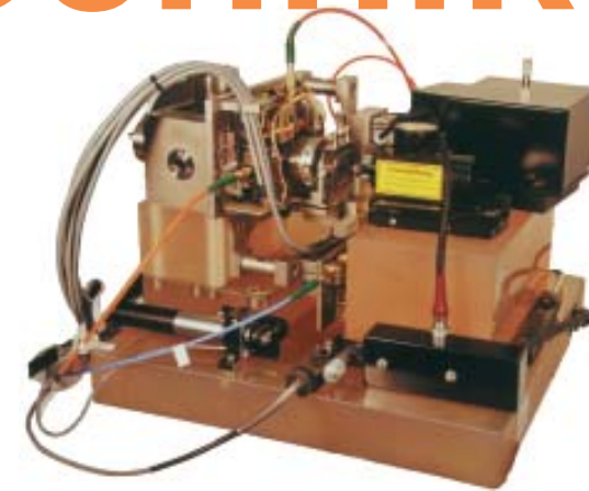
Bild 1a: Rasterkraftmikroskop VERITEKT B, Gesamtansicht
