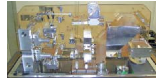
Bild 4: Interferometeraufbau des neuen Nanometerkomparators
