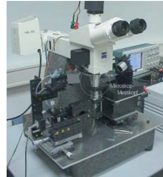
Bild 3: Neu entwickeltes kompaktes optisches Nahfeldmikroskop, dessen Mikroskop-Messkopf in den Revolver eines optischen Standardmikroskops eingeschraubt ist
