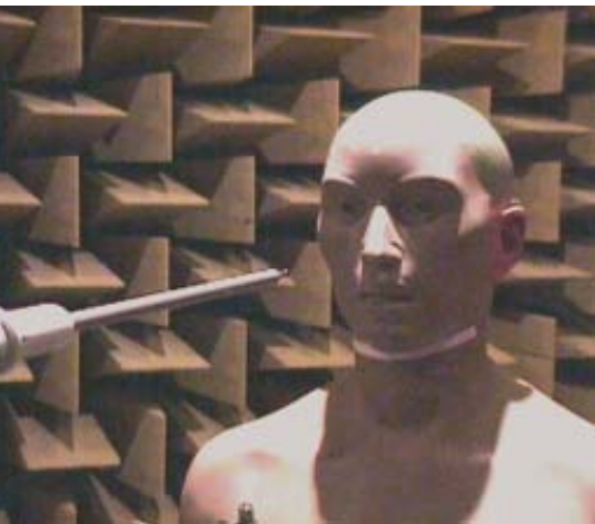
Bild 4: Messung des Schallpegels am Eingang des Gehörgangs mit Hilfe eines Kunstkopfes; das Ultraschallskalpell befindet sich links.
