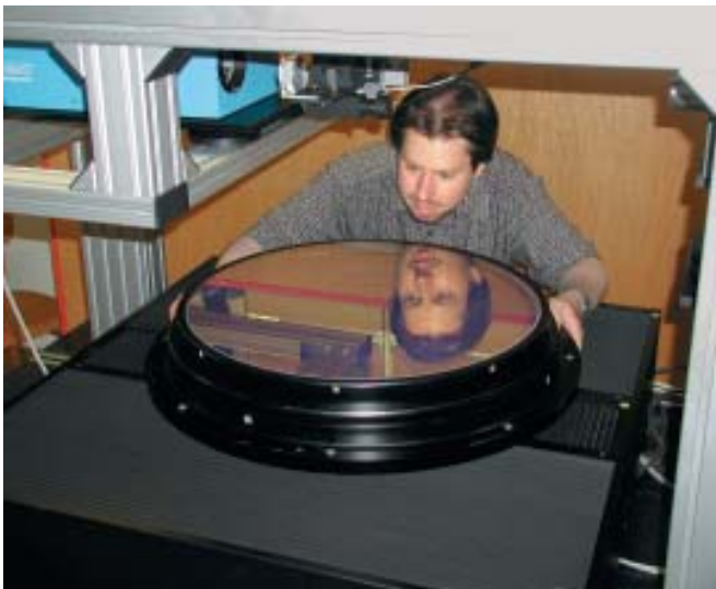
Bild 2: Ebenheitsnormal mit 550 mm Durchmesser am neuen Messplatz für die ultrapräzise Formmessung an ebenen und schwach gekrümmten Flächen
