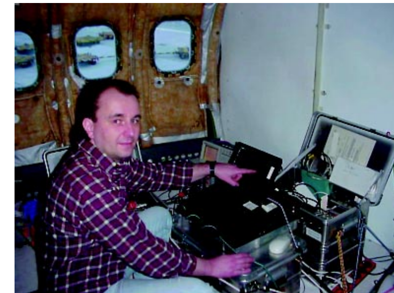
Bild 3: Dosismessungen in einem Frachtflugzeug der Lufthansa Cargo AG
