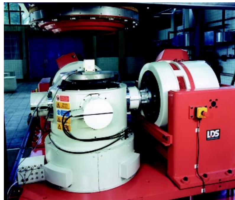
Bild 3: Detailblick auf die Mehrkomponenten-Kalibriereinrichtung
