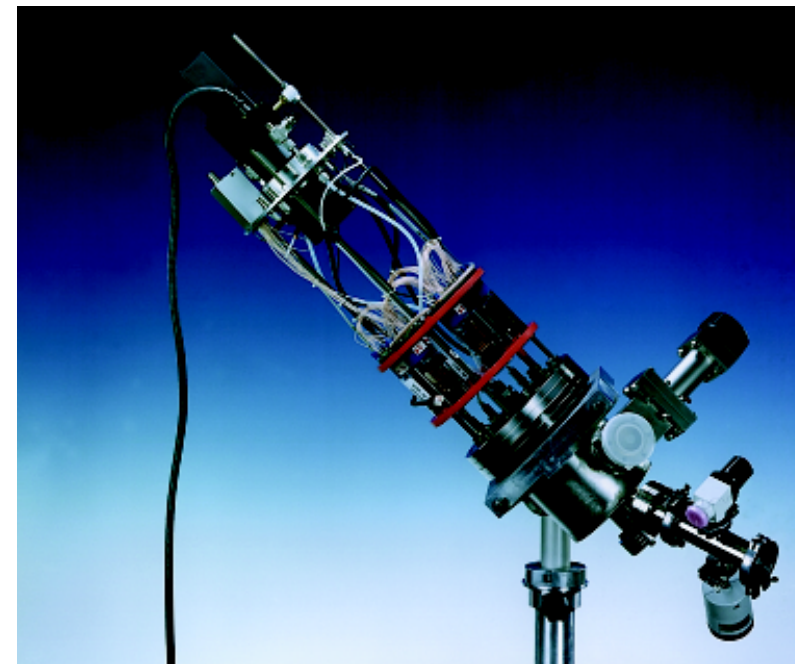
Bild 1: Teilchensporkammer zur dreidimensionalen Darstellung von Spuren ionisierender Teilchen im Mikro- und Nanometerbereich
