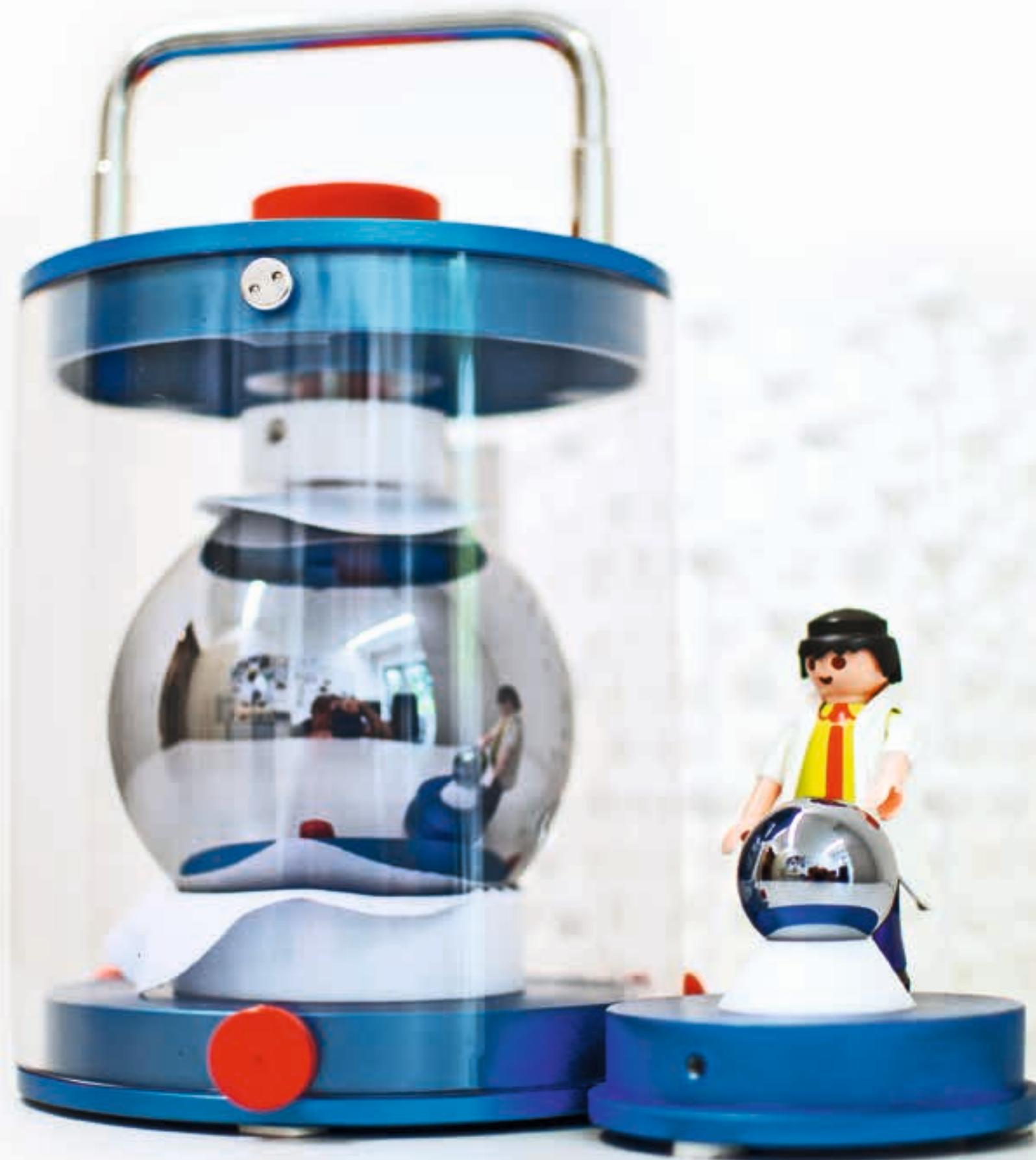
Kugeln für Groß und Klein: eine Mol- und eine Kilogramm-Kugel aus Silizium
