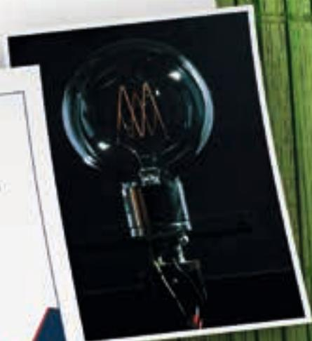
Eine der über 20 Normallampen, mit denen die PTB (neben anderen, radiometrischen Verfahren) die Einheit Candela bewahrt.
