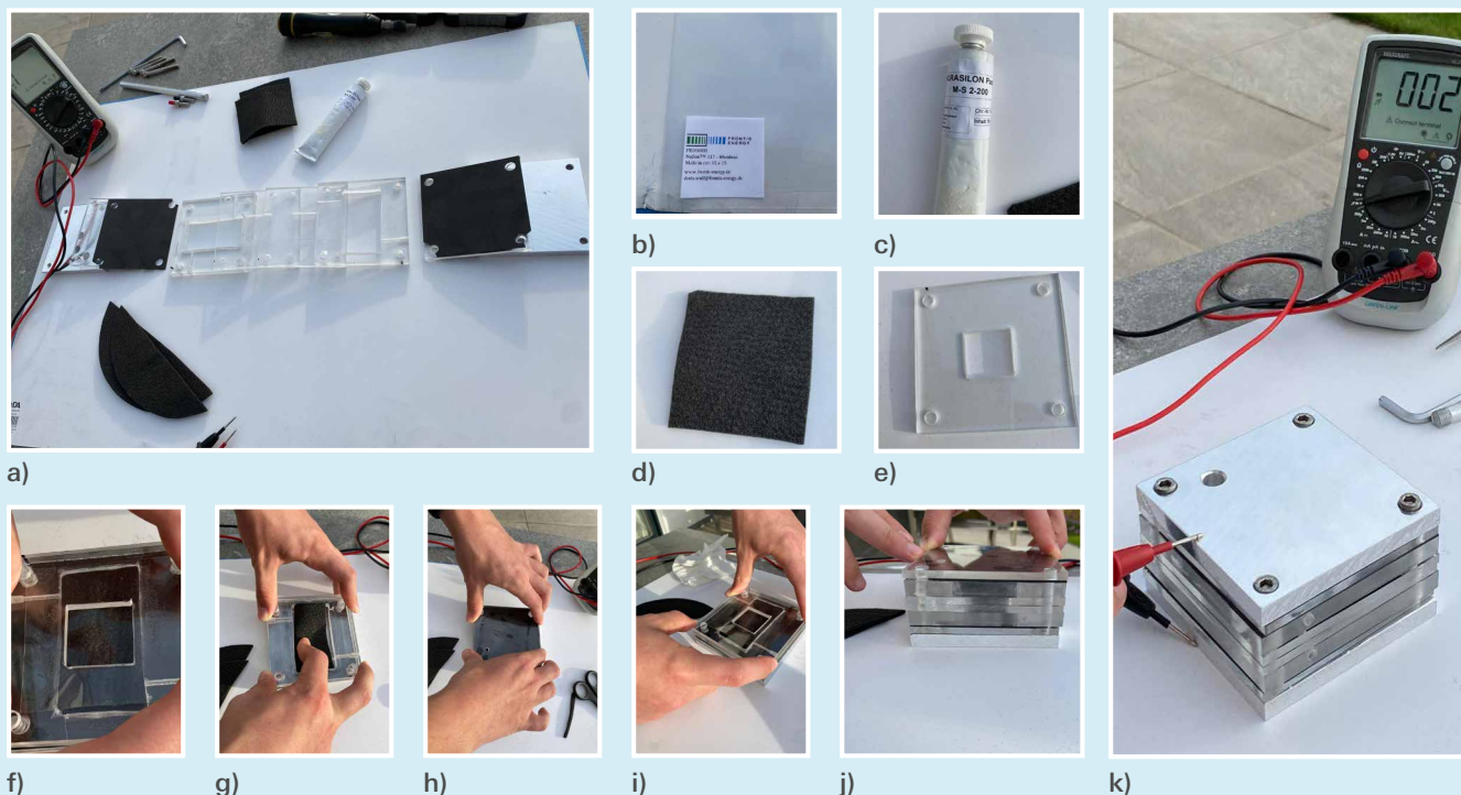
Abb. 8: Bau der Messzelle: (a) von außen nach innen: Aluplatten, Plexiglas als Isolierungsschicht, Graphit als Elektrode, Plexiglas mit Ausschnitt als Messzelle, Plexiglas mit Ausschnitt zur Fixierung der Nafion-117 Membran. (b) Nafion-117 Membran, (c) Schliiffett zur Abdichtung, (d) Graphitfilz zur Vergrößerung der Elektrodenoberfläche, (e) Fenster für die Membran, (f-j) Stapeln der Messzelle und pressen mit Hilfe von Schrauben und der Aluplatten, (k) Prüfung auf Kurzschluss.
