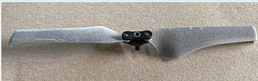
Abb. 12: a) Standardrotoren der Mavic Pro (DJI) b) Präpariertes Design I mit Nabe für Prüfstand c) Präpariertes Design II mit abfallenden Winglets
