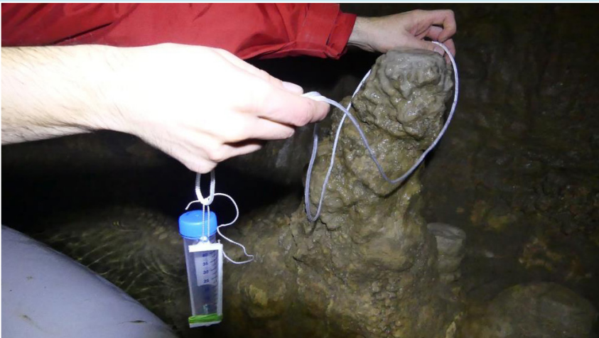
Abb. 12: Eine unserer selbstentwickelten Bojen wird in der Höhle befestigt.
