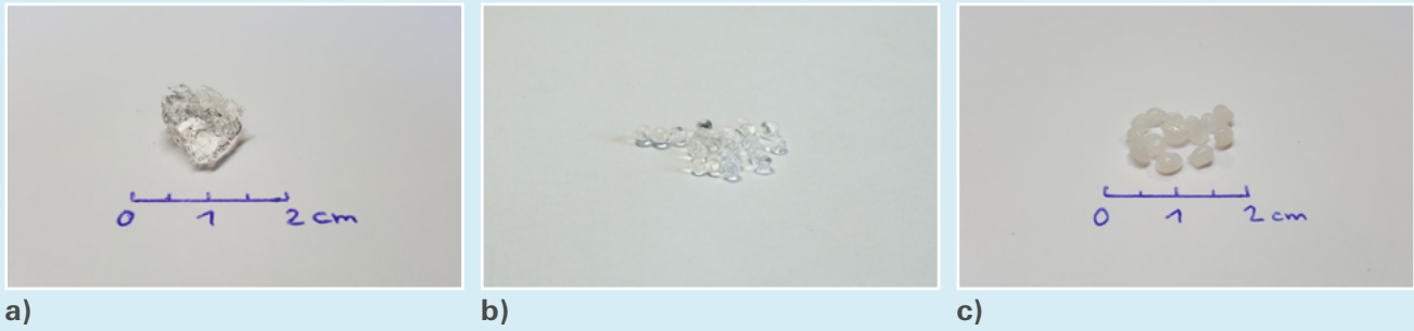
Abb. 4: Chitosan-Hydrogel (links), -Kieselgel (mitte) und -Perlen (rechts)
