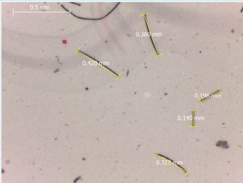
Abb. 8: Ausmessung der Mikroplastikpartikel mit dem Messprogramm Leica Suite
