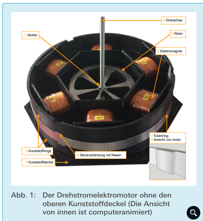
Abb. 2: Aufbau des Drehstromelektromotors
