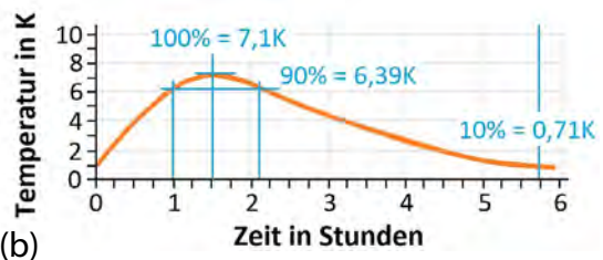
Abb. 12: Temperaturverlauf (a) und Temperaturdifferenz (b) während und nach Verbrennung von 20 g Paraffin im Kachelofen, der im Modelhaus steht
