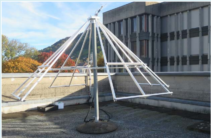
Abb. 1: Die LWA-Antenne am Messstandort. Die Dipole können unterschiedliche Schwingungsrichtungen (Polarisationen) der Radiowellen messen.
