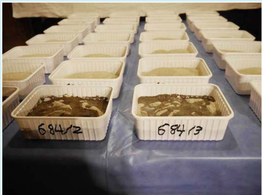
Abb.1 zeigt die Anordnung der Versuchsgefäße, gefüllt mit Grundsubstrat. In der vorderen Reihe wurde bereits Wasser hinzugefügt.
