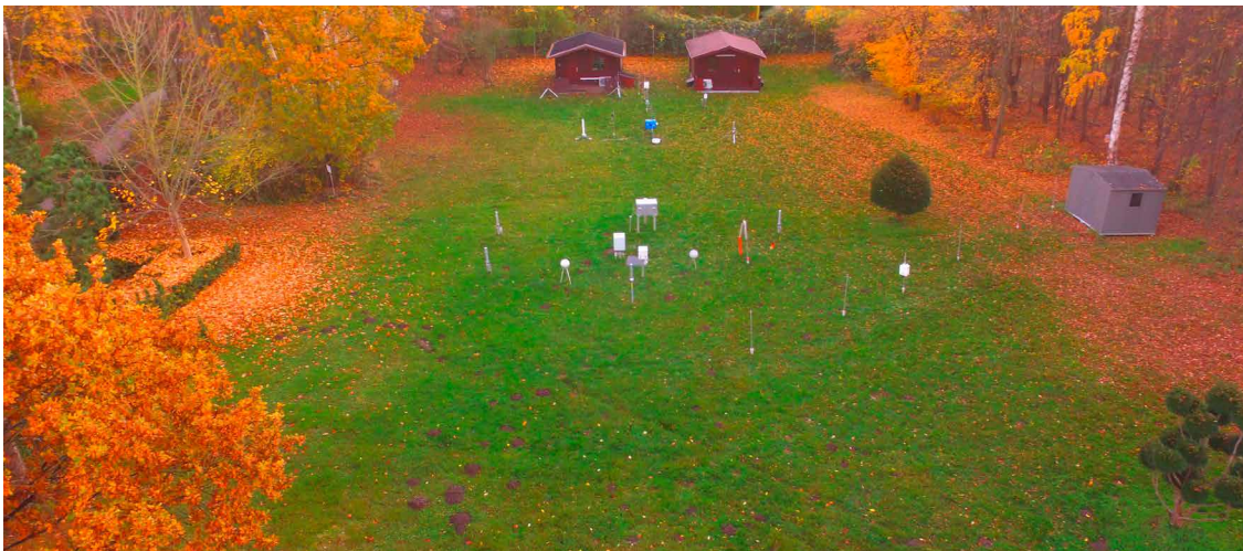
Abbildung 1: Die Referenzfläche (ERADOS) der PTB im Herbst 2021. Eine Erweiterung der Instrumentierung ermöglicht es, die Metrologieforschung zur Überwachung der Ortsdosisleistung in der Umwelt mit neuen Methoden für die Klimabeobachtung zu kombinieren.
