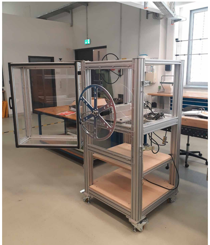
Abbildung 4: Foto des Grundaufbaus zum „Mikrofonkarussell“ zur alternativen Primärkalibrierung von Mikrofonen im Infraschallfrequenzbereich
