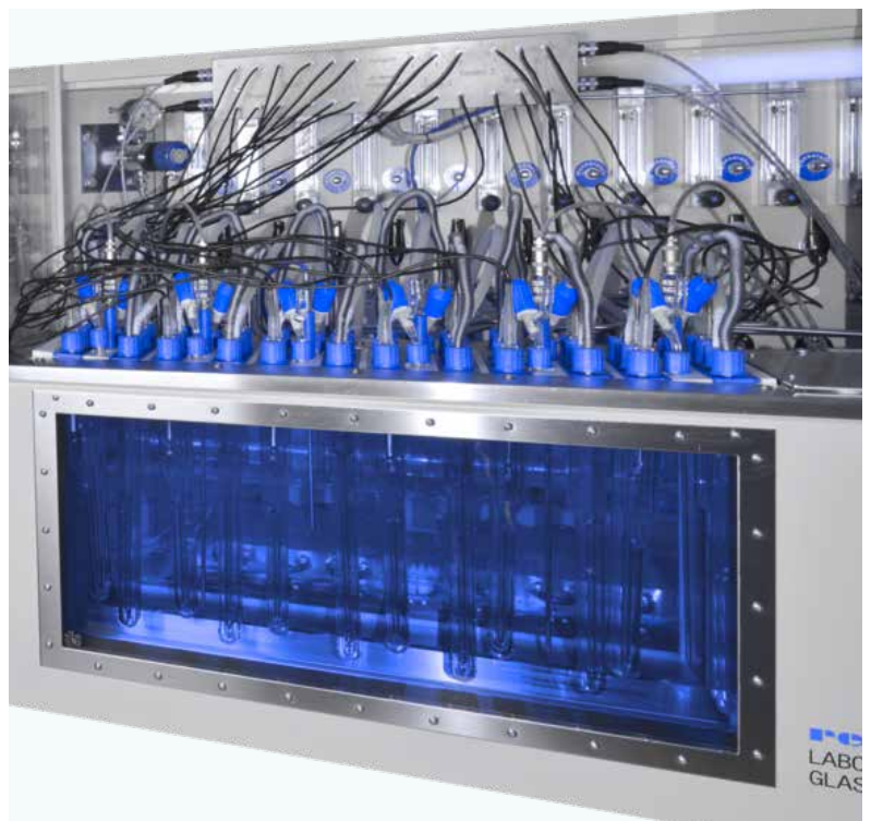
Abbildung 3: Messapparatur der PTB zur elektrochemischen Messung des \text{pH}_T -Wertes. Die Apparatur enthält die mit den künstlichen Meerwasserproben gefüllten Harned-Zellen, deren Potentiale mithilfe eines Digitalmultimeters unter temperierten Bedingungen gemessen werden.
