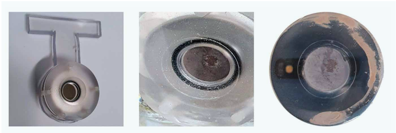
Abbildung 9: Herstellung der ^{210}\text{Po} -Quelle, von links nach rechts: 1) Silber-Target im PMMA-Halter, 2) Silber-Target im Halter in der ^{210}\text{Po} -Lösung, 3) Trockene, noch ungereinigte ^{210}\text{Po} -Quelle auf Silber-Target
