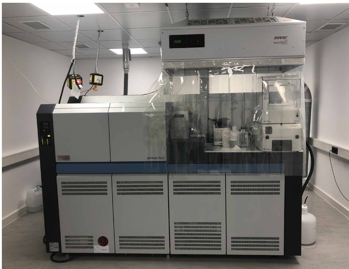
Abbildung 2: Das „Multi-Collector Inductively Coupled Plasma Mass Spectrometer“ der PTB für die Messung von Uran- und Plutonium-Isotopen in der Umwelt
