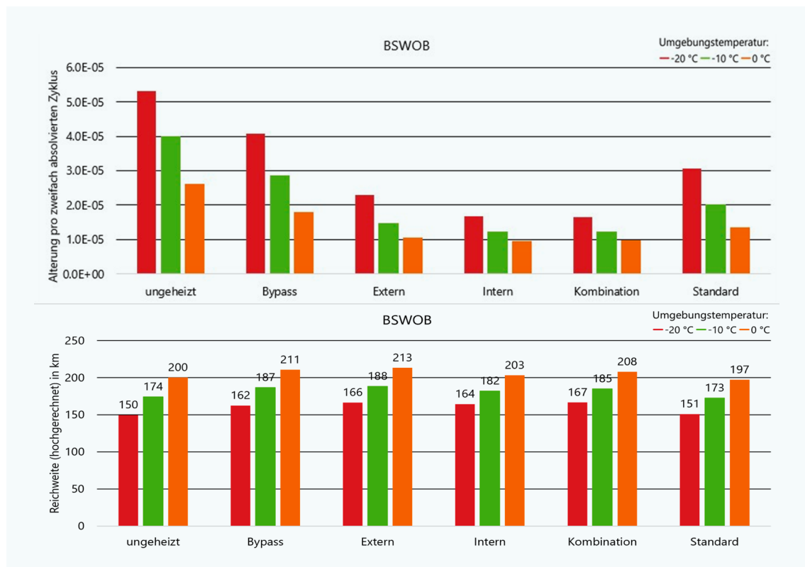
Abbildung 11: Alterung/SOH-Verlust (oben) und Restreichweite (unten) für eine Fahrt von Braunschweig nach Wolfsburg und zurück bei definierten Winterfällen und Heizkonzepten. Ungeheizt: Kein Heizkonzept, Bypass: Heizung durch Bypass aus Leistungselektronikkreislauf, Extern: Wärmepumpe, Intern: Selbstheizende Strukturen in den Batteriezellen, Kombination: Wärmepumpe und selbstheizende Strukturen in Batteriezellen, Standard: Hochvoltheizer.
