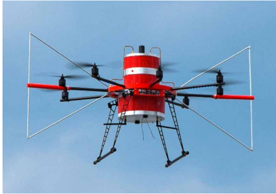
Abbildung 1: Modifizierter Okto- kopter zur Messung des Winkelfehlers beim CVOR und DVOR.
