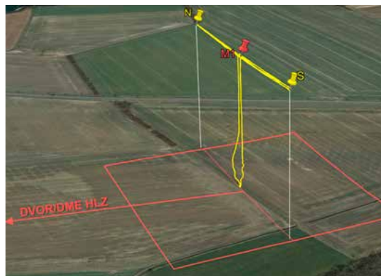
Abbildung 6: T-Profil des Fluges am Messort M1 in der Nähe der Windkraftanlagen beim DVOR Hehlingen (Quelle: Google Earth).
