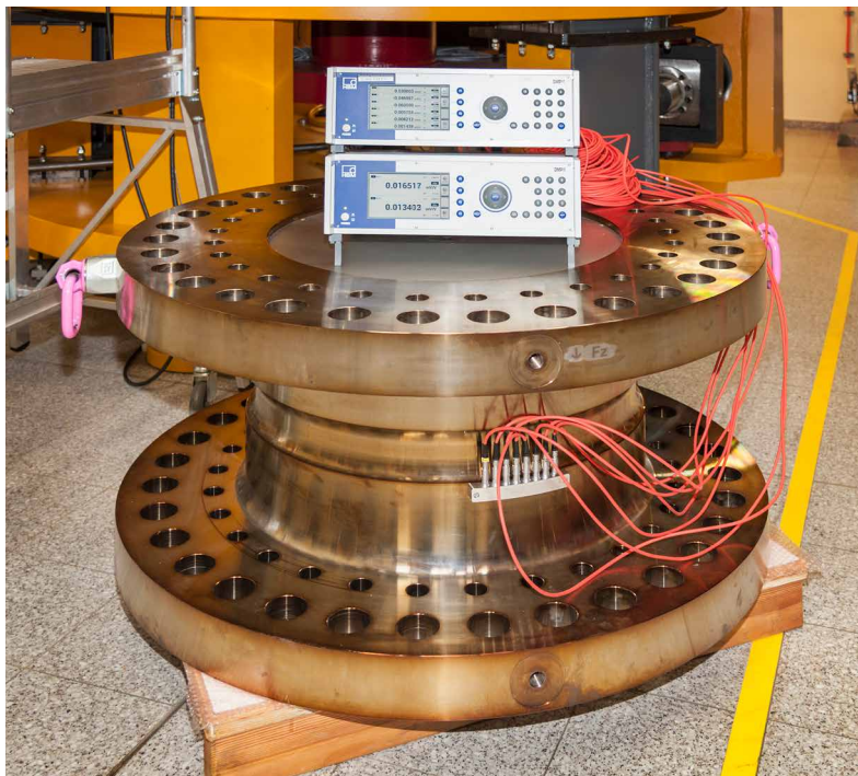
Abbildung 20: 5-MN·m-Drehmomentaufnehmer der PTB
