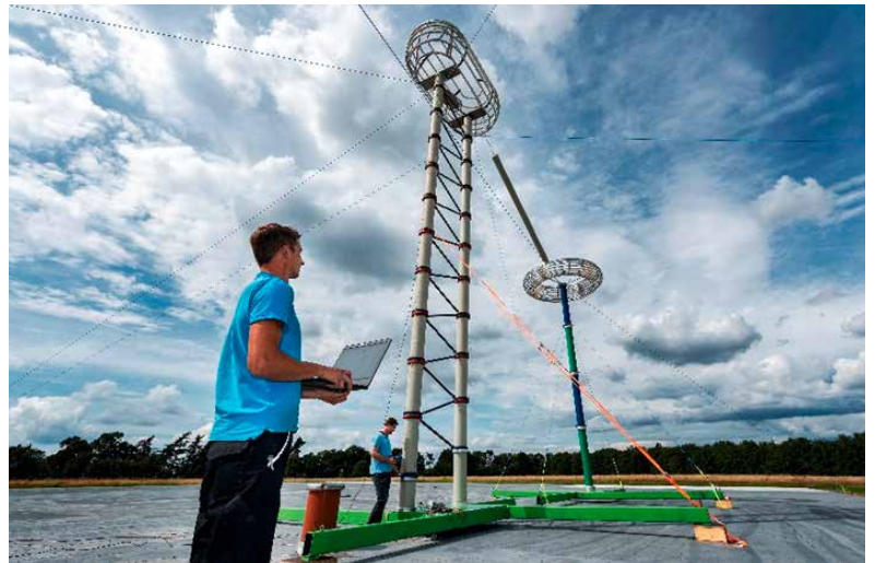
Abbildung 1: Die Messeinrichtung auf dem Freifeld der PTB besteht aus einem Hochspannungserzeuger (im Vordergrund), der Gleichspannungen von bis zu 2 Millionen Volt erzeugen kann. Im Hintergrund steht der Messteiler, welcher diese Spannung präzise erfasst. (Foto: PTB)
