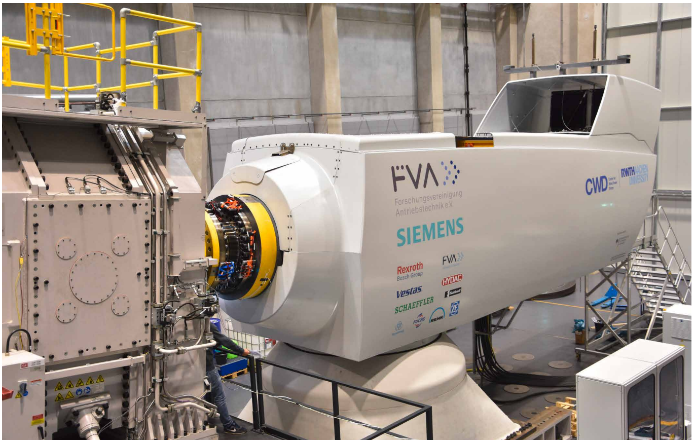
Abbildung 19: Gondelprüfstand des CWD Aachen mit eingespannter Gondel – zwischen der Lasteinleitungseinheit (links) und der Gondel (rechts) ist der 5-MN·m-Drehmomentaufnehmer der PTB eingebaut (Quelle: CWD Aachen)
