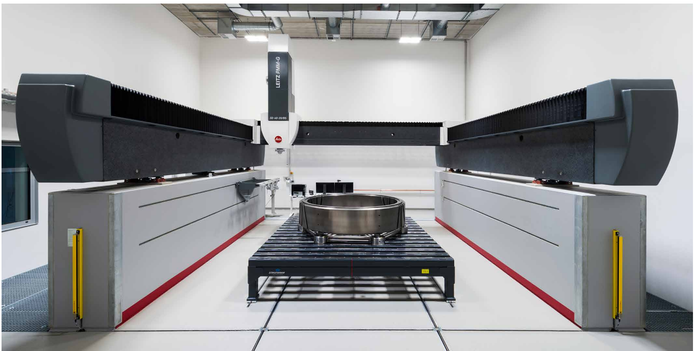
Abbildung 2: Das neue Groß-KMG der PTB im CCW
