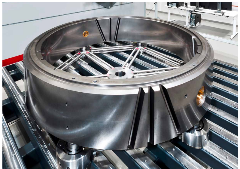
Abbildung 4: Großverzahnungsringnormal mit 2 m im Durchmesser
