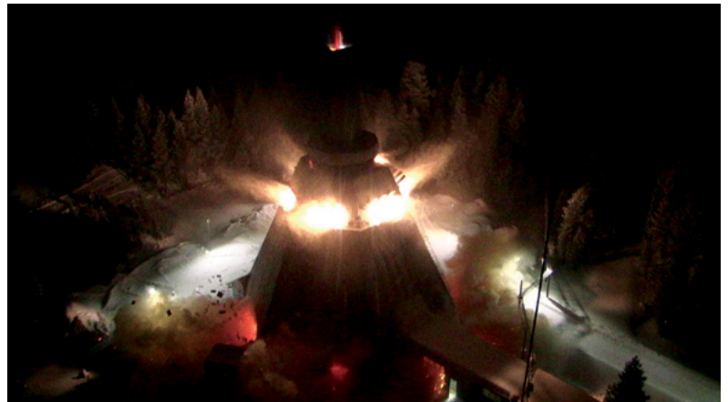
Abbildung 7.3: Start der MAIUS-1-Mission. Die Nutzlast verlässt die Startvorrichtung oben. Während der Brennphase wird die Apparatur durch Beschleunigungen von bis zu 12 g und Vibrationen bei bis zu 5.41 g_{rms} belastet.
