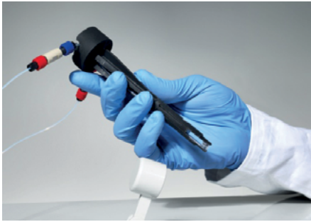
Generativ gefertigte Halterung (schwarz) der Flusskapillare mit spiralförmigem Aufbau beim Einsetzen in das MPS
